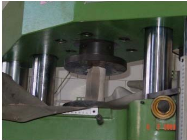
Ek A.6 Yük artışıyla karotlarda oluşan deformasyonlar
