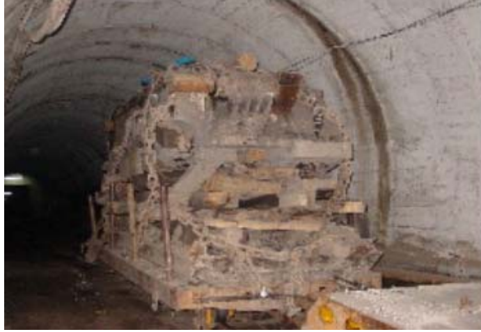
Ek B.2 Kesici makinenin kulikar ile ocak dışına çıkarılması
