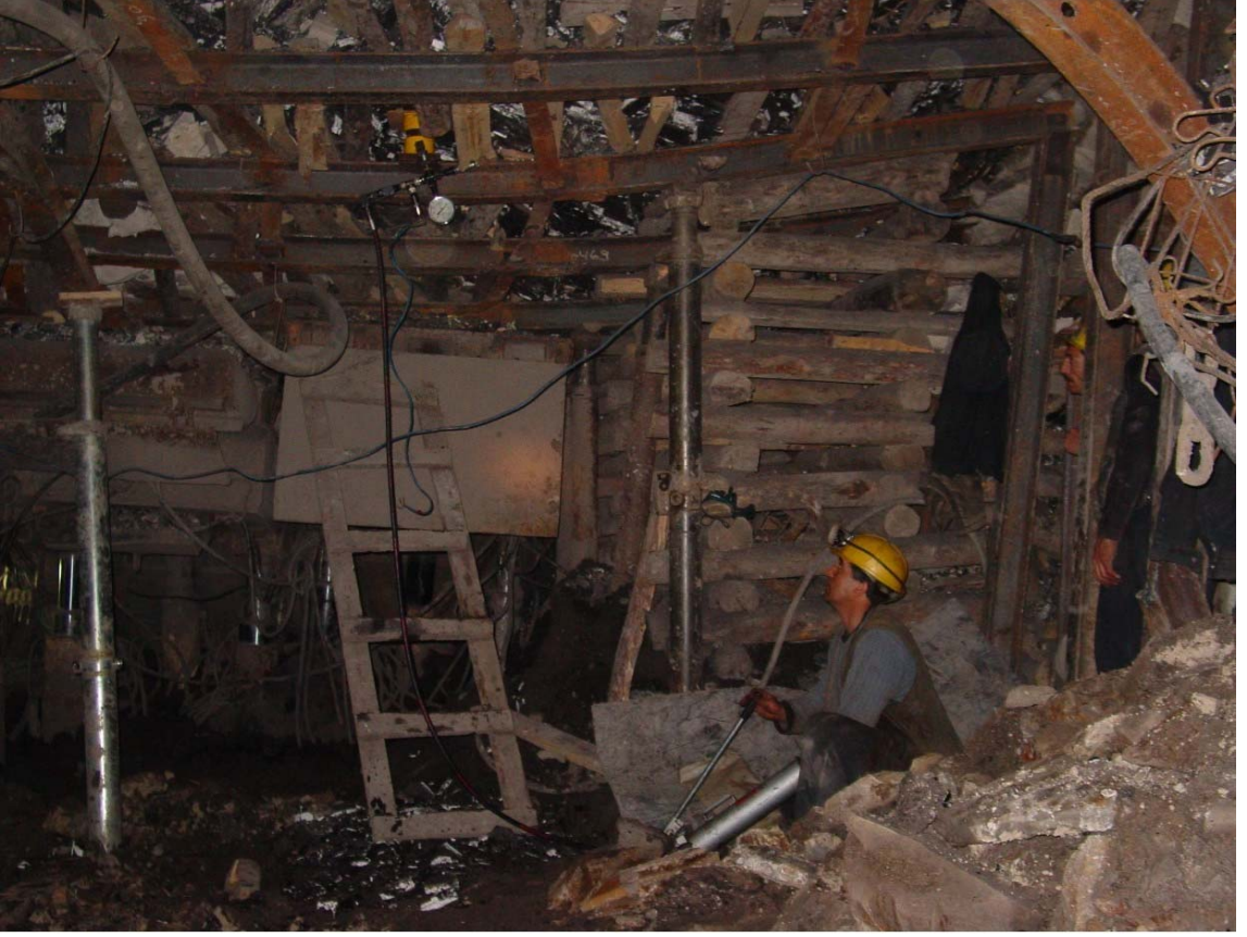
Ek F.1 Pistonlara hidrolik kriko ile ön yükleme yapılması
