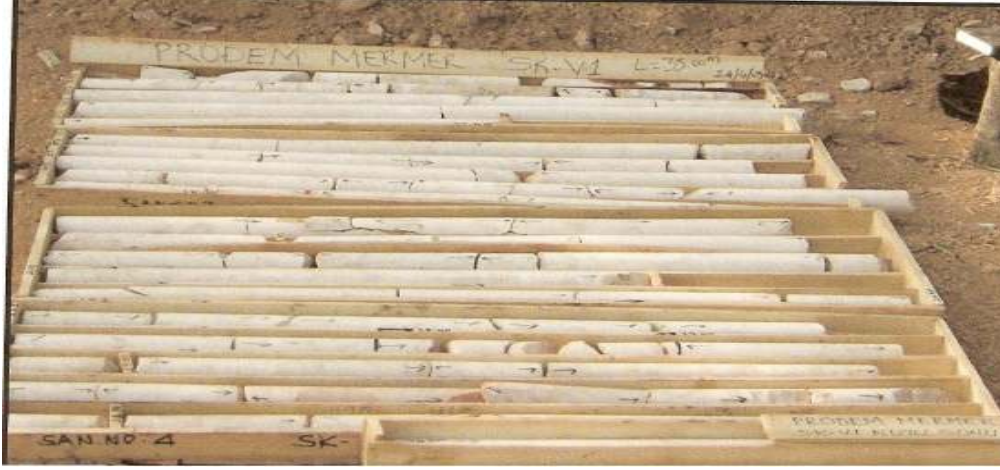
Şekil 5.3 (SKV-1), 1 numaralı sondaja ait karot numuneleri
