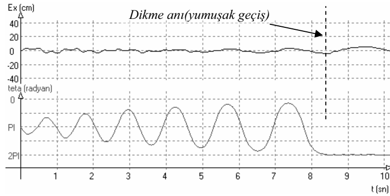
Şekil 5.62 Deney 14, yumuşak geçişli dikme deneyi ( K_{ps}=200, K_{ds}=50, K_{pa}=150, K_{da}=125 )
