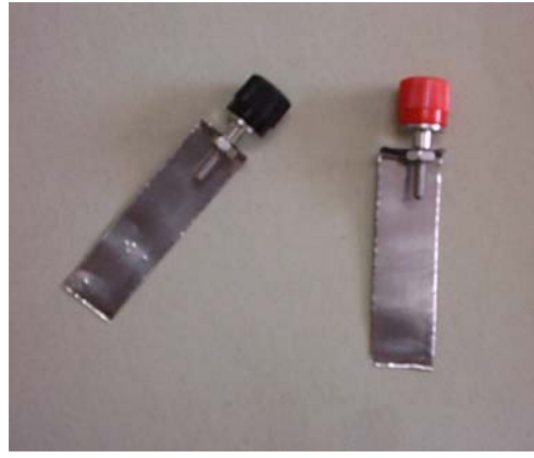
Şekil 5.15. Soket yuvalarına tutturulmuş metal folyolar.
