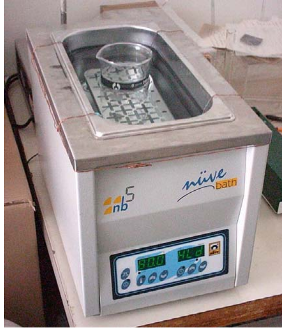
Şekil 5.4. Zar kirliliğinin temizlenmesinde kullanılan su banyosu.
