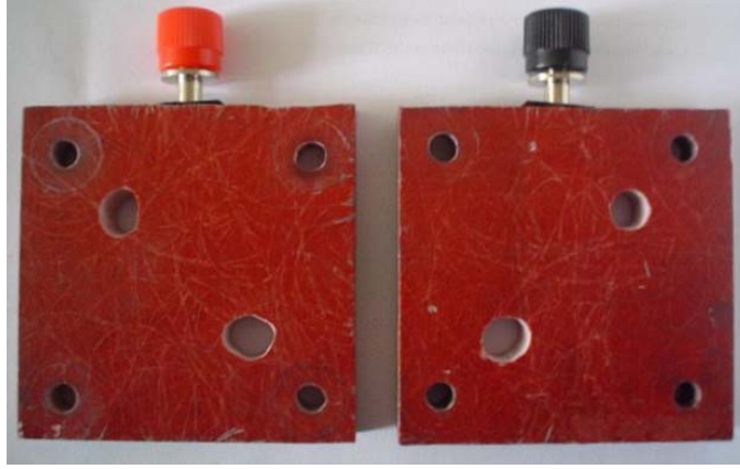
Şekil 5.16. Hidrojen/oksijen beslemeli proton değişim zarlı yakıt hücresi tutucuları.
