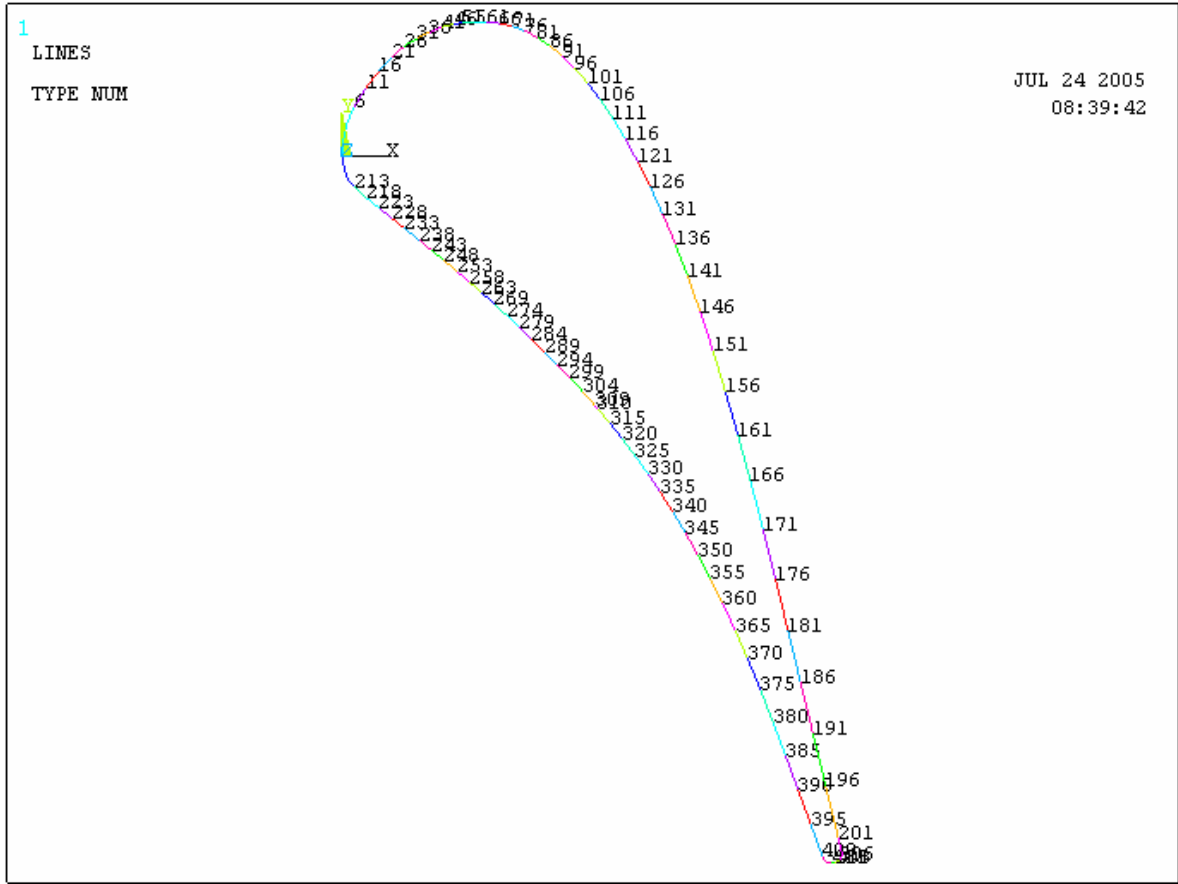
Şekil A 1. Kanatçık profilinin imalat koordinatlarına göre oluşturulan ANSYS modeli
