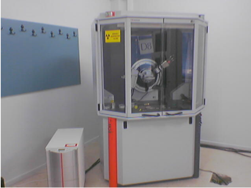
Şekil 8.6. Bruker D8 Advance marka XRD cihazı
