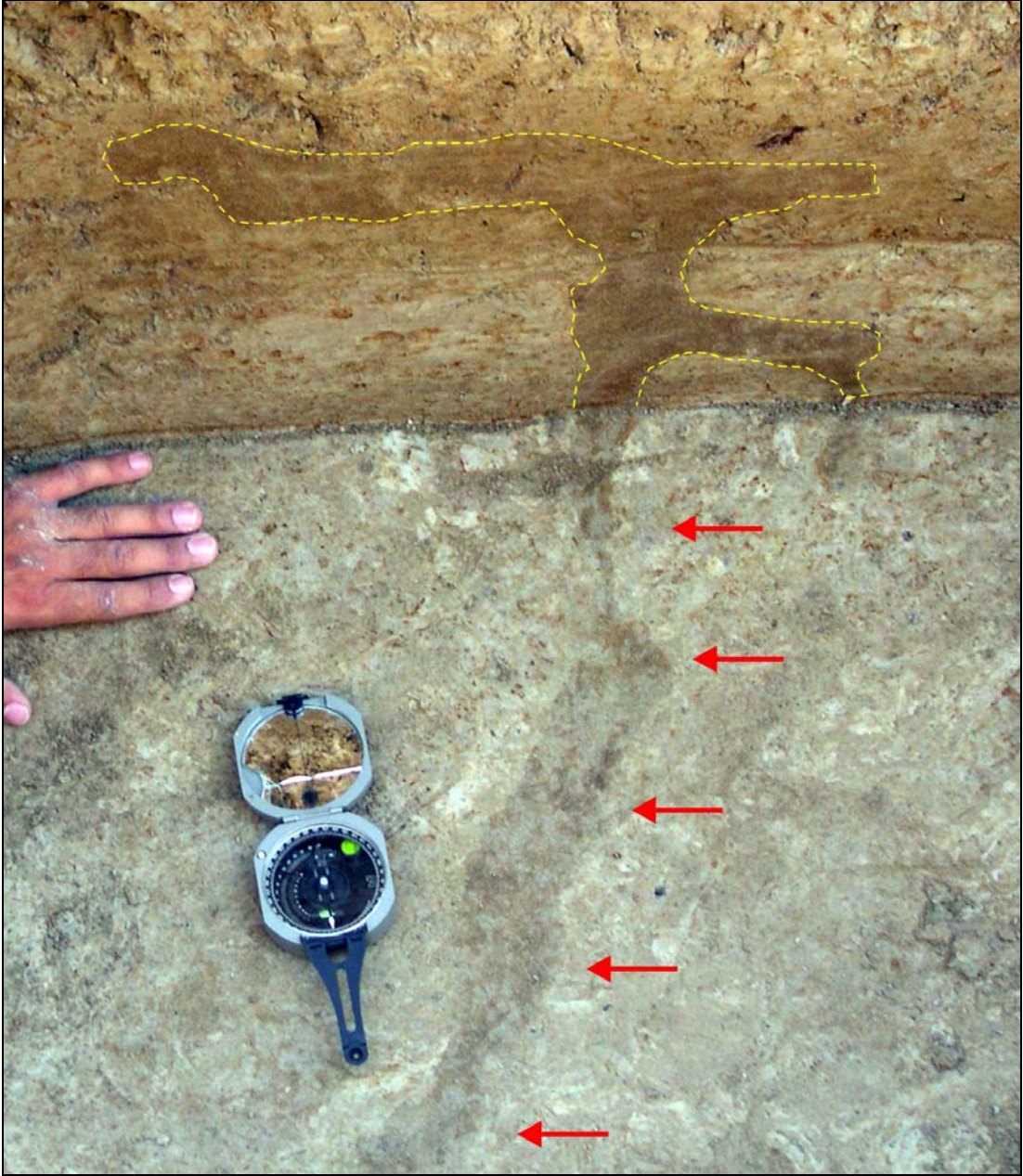
Şekil 5.20. Demirköprü Hendeği tabanında eski bir depreme ait yüzey kırığı ve bu kırık boyunca hendek duvarında gözlenen kum fişkırması (kırmızı oklar hendek tabanında yaklaşık K20^0D doğrultusunda uzanan kırığı, sarı kesikli çizgi ise hendek duvarında gözlenen kum fişkırmasını göstermektedir).
