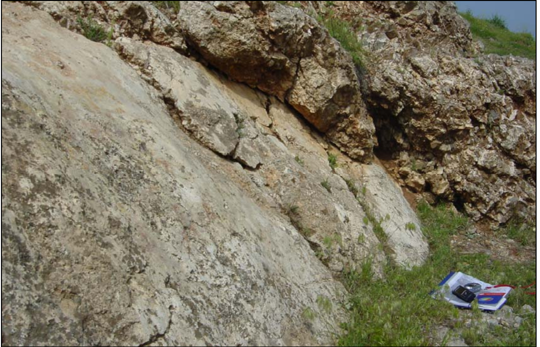
Şekil 3.58. Haltanlı ve İslahiye arasında doğrultu atımlı fay zonu batısında K70^0D / 65^0GD konumlu bir fay düzlemi.
