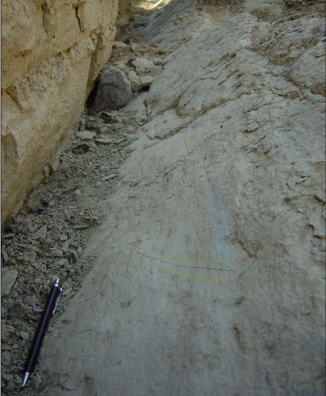
Şekil 3.15. Karsu Fayı'na ait K10^0D/55^0GD konumlu fay aynası üzerinde yatayla yaklaşık 45^0 açı yapan çizikler gözlenmektedir (düzlem üzerindeki çizgi yatayı göstermektedir).
