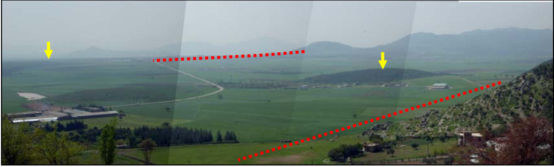
Şekil 3.60. İslahiye kuzeyinde fay doğrultusunda yaklaşık 2,5 km'lik bir sola sıçrama meydana gelmektedir. Sıçrama yapan heriki fay uzanımı arasında kalan bu geniş alan irili ufaklı volkanik çıkış merkezleri ile çevrilidir (Resim Fevzipaşa güneyinden güneye bakışı göstermektedir).
