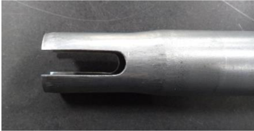
Şekil 4.7 Yarık açma operasyonu sonrasında görünüş
