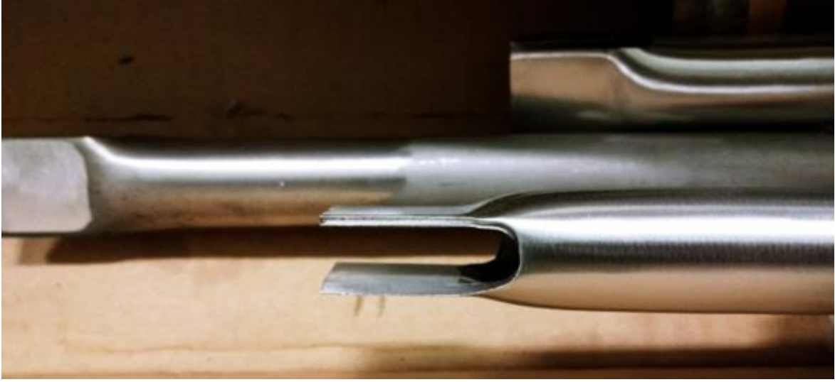
Şekil 4.9 Kulak açma operasyonu sonrası parçalarda görünüm
