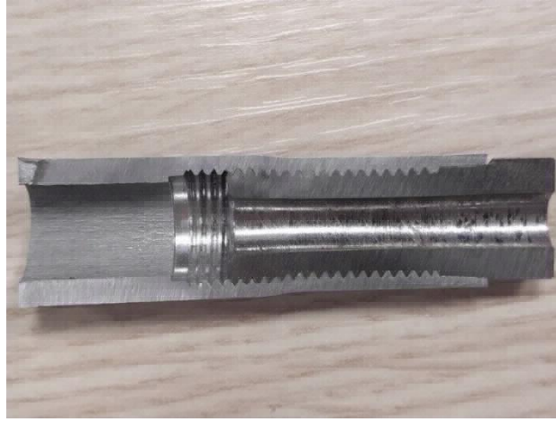
Şekil 1.3 Montaj edilmiş “Push Rod” gövde ve insert parçalarının montaj edilen kısmının kesiti
