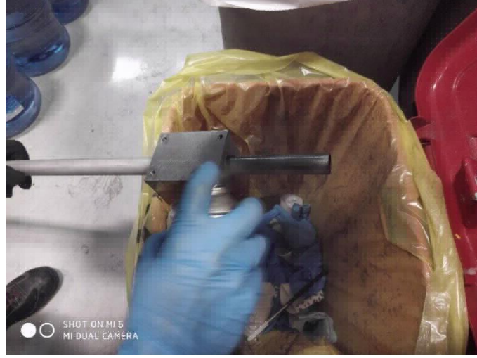
Şekil 3.9 Boru yüzeylerine kuru film yağlayıcı uygulanması
