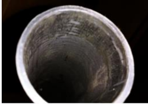
Şekil 4.13 Boru ucu şişirildikten sonra boru iç yüzey görünüşü
