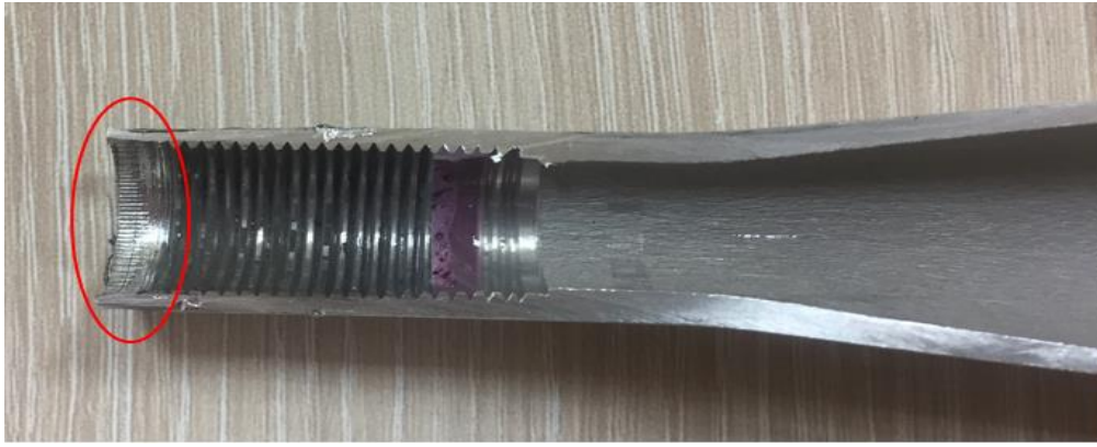
Şekil 1.4 Alüminyum gövdede olan “Clevis” tırtıklarından kaynaklanan deformasyon
