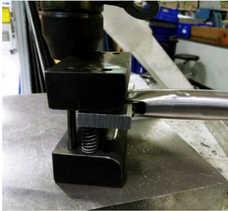
Şekil 4.8 Hidrolik preste kulak açma operasyonu
