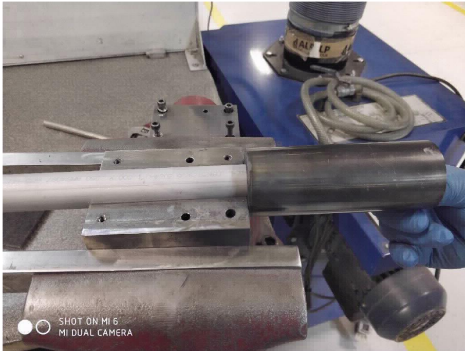
Şekil 3.8 Tutucu fikstürün bağlama bölgesinin belirlenmesi
