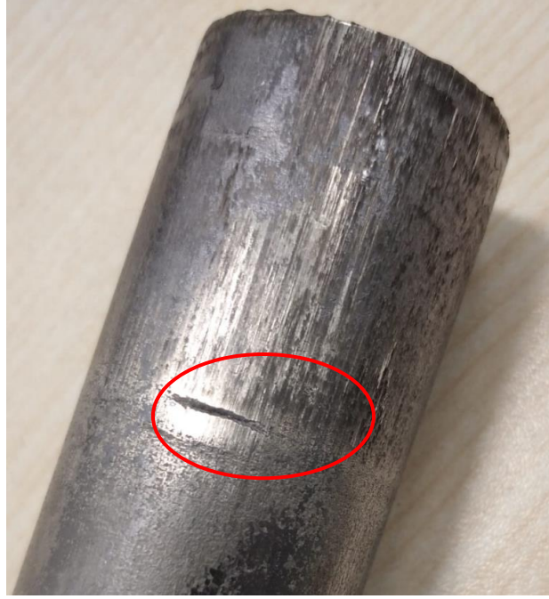
Şekil 4.3 Başarısız şişirme denemesinde görülen şekilsel hatalar
