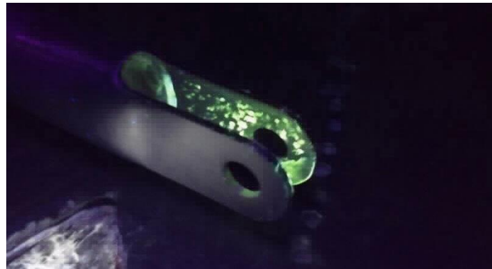
Şekil 4.12 Floresan penetrant muayenesinde görülen mikro çatlaklar
