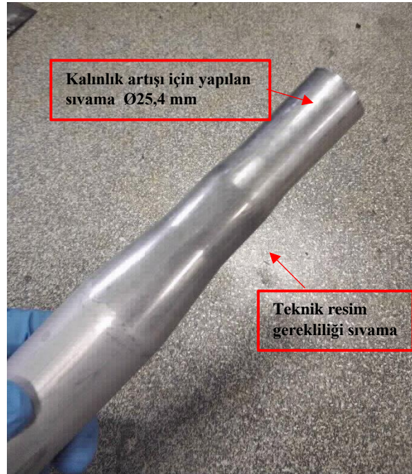
Şekil 4.6 Sıvama sonrası çap düşümü
