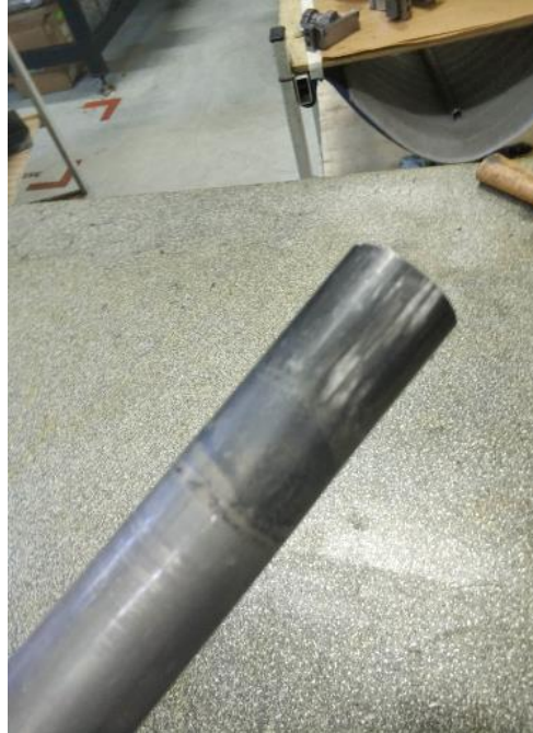
Şekil 4.2 Şişirme işlemi sonrası borunun dış yüzeyi
