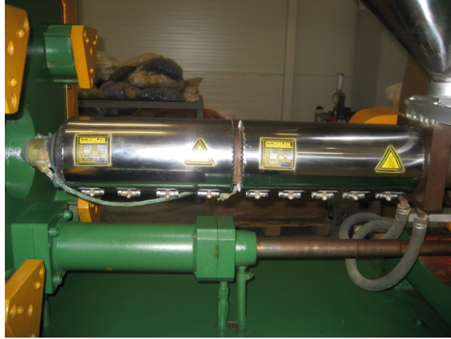
Şekil 4.4. Plastik enjeksiyon makinesinde enjeksiyon vidası
