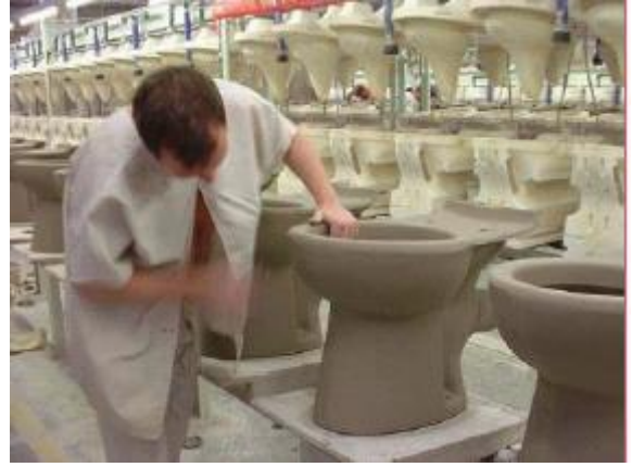
Şekil 3.10. Yarı mamul üzerinde kesme oyma işlemi (Twyford, 2005; MEGEP, 2007).
