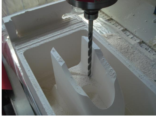
Şekil 2.3. Model kalıbın CNC’de işlenmesi
