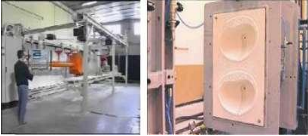
Şekil 3.12. Yüksek basınçlı döküm yöntemi ile lavabo şekillendirme (MEGEP, 2007)
