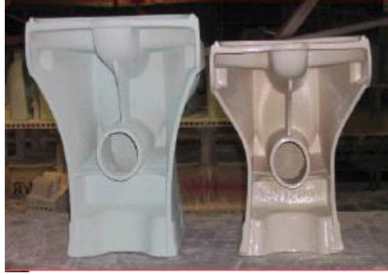
Şekil 2.1. Belli bir oranda büyütülmüş model ve nihai ürün karşılaştırması (Twyford, 2005)
