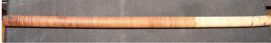
Şekil 3.5. 12 mm çapındaki bir artım kalemi örneği.
