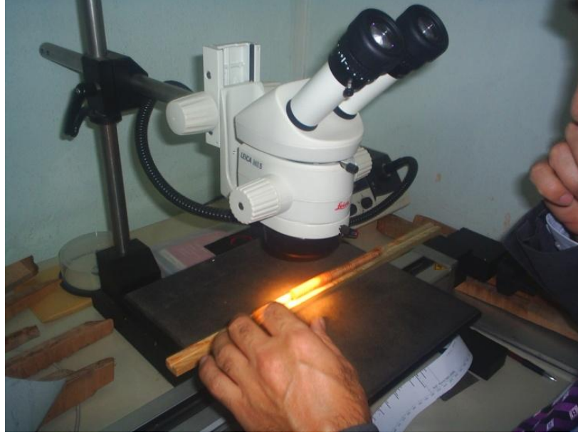
Şekil 3.6. LINTAB-TSAP sisteminde örneklerin yıllık halkalarının ölçülmesi.
