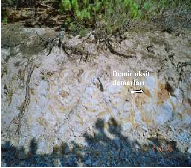
Şekil 3.1.1.4. Yüylük köyü kaolen yatağında demir oksit damarlarının görünümü.
