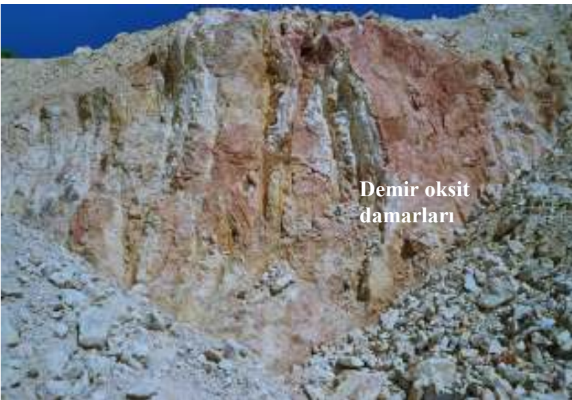
Şekil 3.1.1.2. Yüyük kaolen yatağında demir oksit damarları görünümü.
