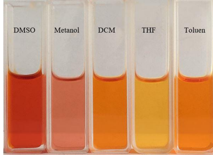
Şekil 5.16. Azoboya5 bileşiğinin farklı çözücüler içerisinde gün ışığında alınan dijital fotoğrafı
