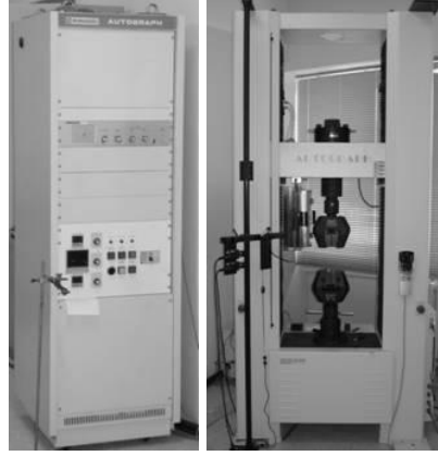
Şekil 7.9. SHIMADZU-AG-IS 250kN ÜNİVERSAL TEST CİHAZI: Bilgisayar kontrollü sıcaklık ünitesi üniversal test cihazı (Maksimum yük = 250 kN).
