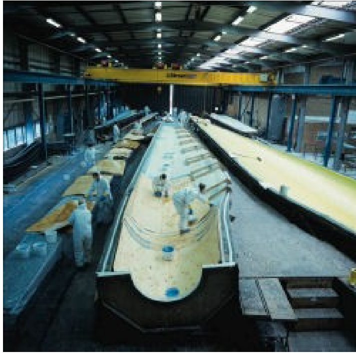
Şekil 2.7. Kalıplama yöntemiyle kompozit kanat üretimi ( http://www.eng.cam.ac.uk/news/stories/2007/bamboo_wind_turbines , 2011).
