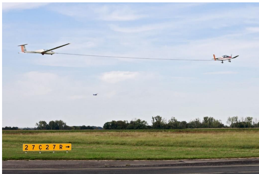
Şekil 1.8. Tayyare Römorku (Uçak arkasında) ile kalkış (Anonim, 2016).
