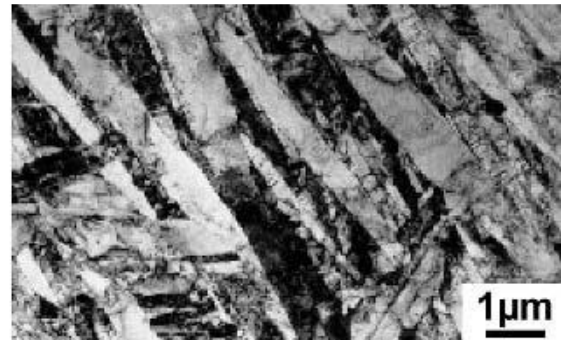
Şekil 2.7. \beta faz bölgesinden hızlı soğutulmuş "Asiküler" martenzit (Ti6Al4V) (a) Işık mikroskobu (b) TEM (Lütjering ve Williams, 2007).
