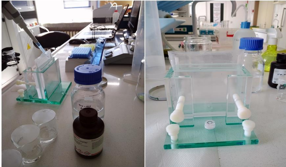
Şekil 3. 7. Hazırlanan SDS-PAGE jelinin elektroforez camlarının arasına doldurulması
