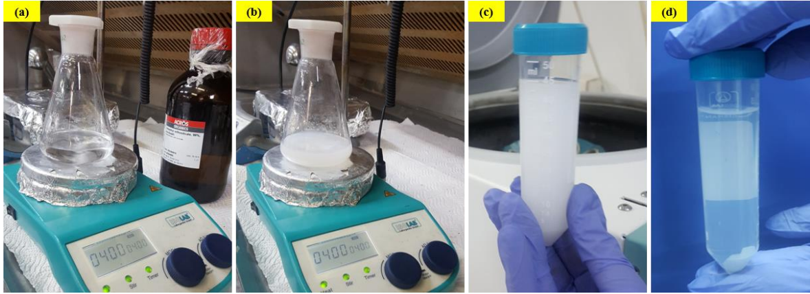
Şekil 4.5. SiO 2 nanopartikül üretim aşamaları (a) başlangıç, (b) 6 saat sonra, (c, d) santrifüj öncesi ve sonrası.
