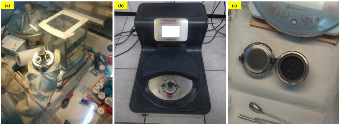
Şekil 4.12. Mekanik alaşımlandırma öncesi (a) tozların tartılması (b) kullanılan bilyalı değirmen (c) mekanik alaşımlandırma sonrası.
