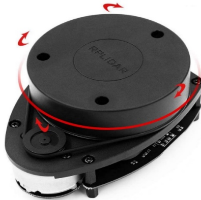
Şekil 3.10. 360° Tarama Özelliğine Sahip RPLIDAR A1M8
