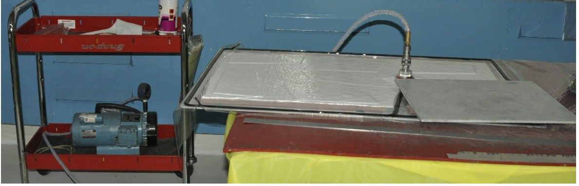
Őekil 4.18. Vakum uygulaması
