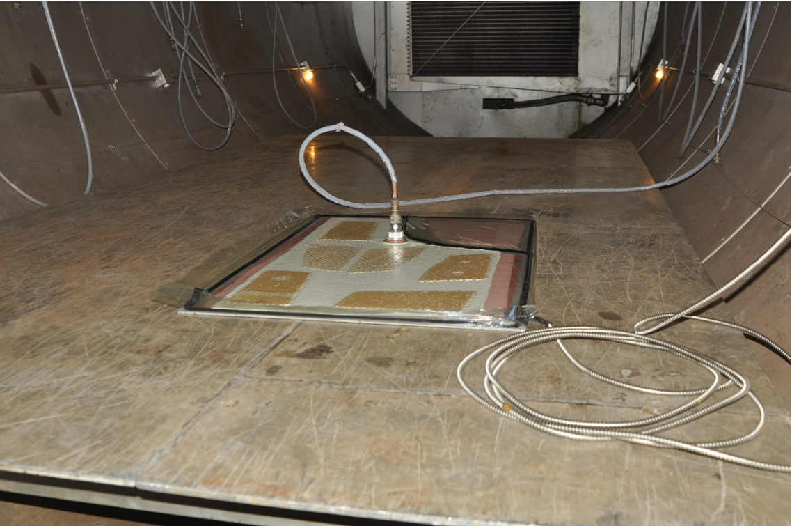
Şekil 4.20 Kür döngüsü sonrası vakum çantasındaki test parçaları
