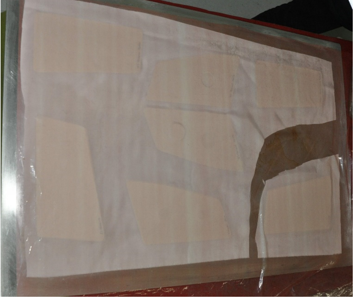
Şekil 4.15. Sıyırma katmanı yerleştirilmesi
