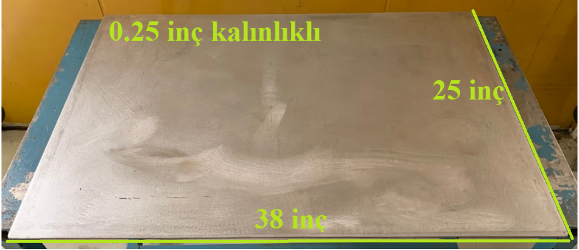
Şekil 4.10. Kompozit İmalatı için Kalıp Malzemesi
