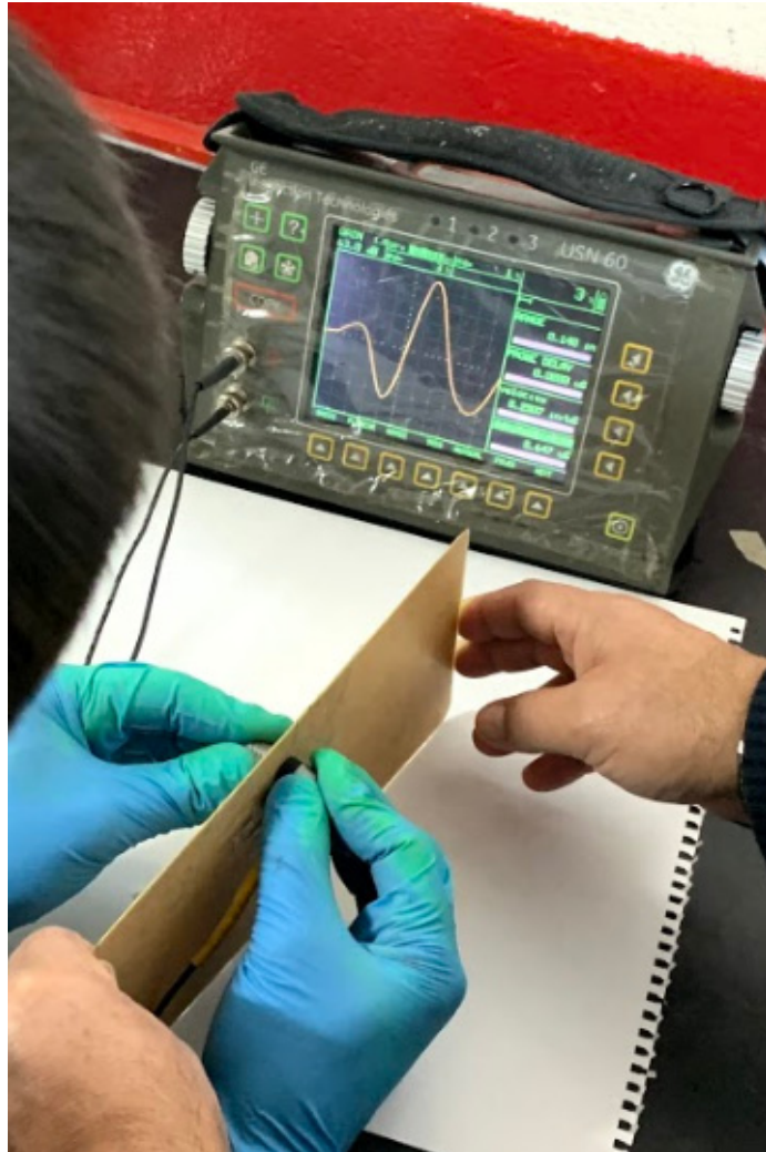
Şekil 4.54. Altıncı Test Parçası Ultrasonik Kontrolü
