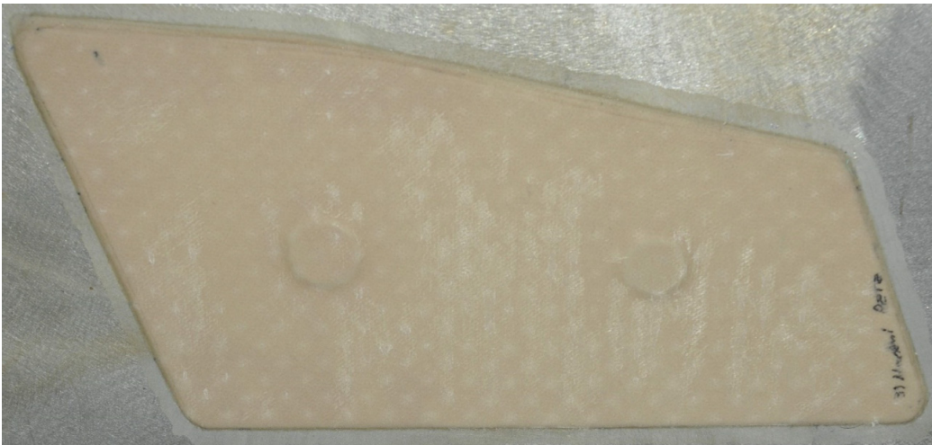
Şekil 4.26. Kürlenmiş üçüncü test parçası
