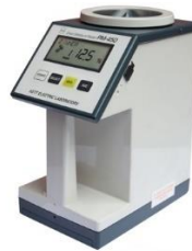
Şekil 3.6. Denemede kullanılan hektolitre ağırlık ölçme cihazı
