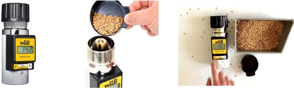
Şekil 3.5. Denemede kullanılan tahıl nem ölçer cihazı
