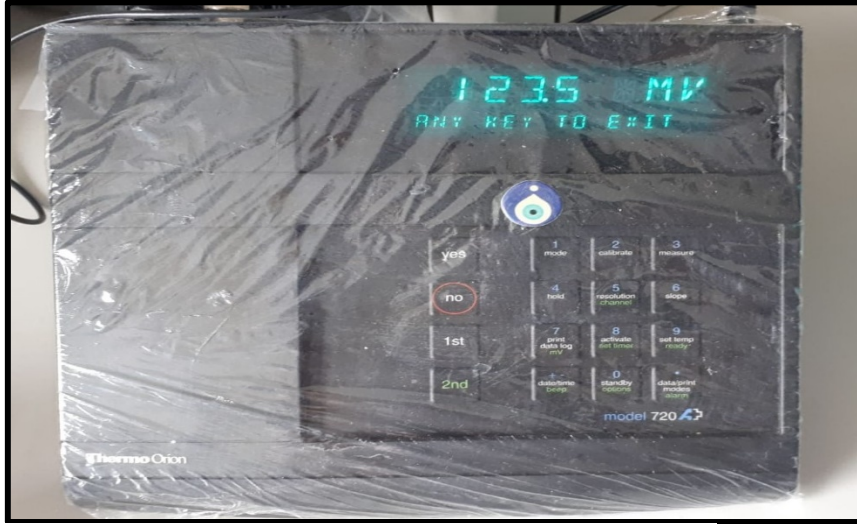
Şekil 3.9. Thermo Orion 720 A+ iyonmetre cihazı
