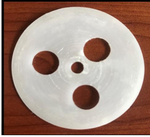
Şekil 3.5. Örneklerin hazırlanmasında kullanılan polietilen kalıp
