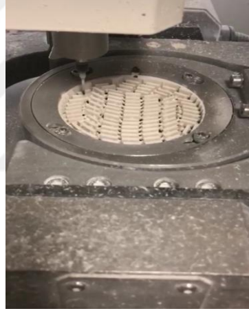
Şekil 3.4. PEEK örneklerin Yenadent frez cihazı ile hazırlanması
