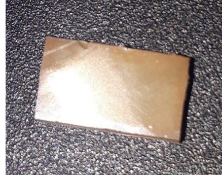
Şekil 3.14. Altın kaplama cihazı Leica EM ACE600, Altın-paladyum kaplanmış PEEK örnek
