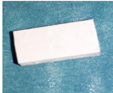
Şekil 3.5. Yenadent frez cihazı ile hazırlanmış 10 mm×5 mm×2 mm boyutlarında PEEK örnek
