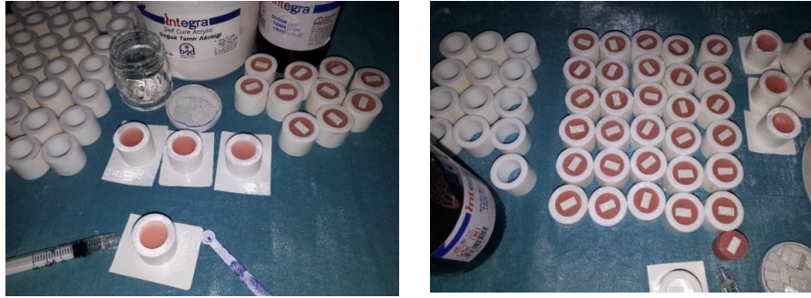
Şekil 3.7. PEEK örneklerin otopolimerize akrilik rezine gömülmesi
