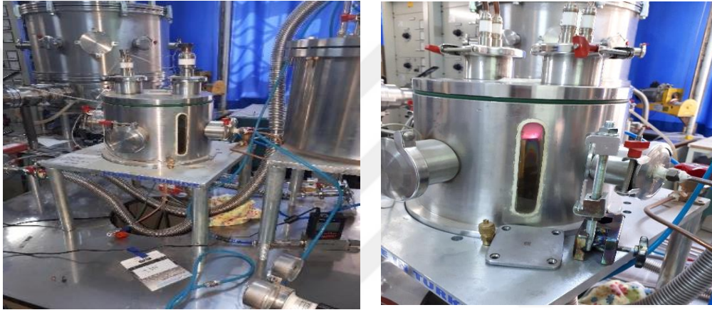
Şekil 3.10. RF sıçratma sistemi vakum odası, plazma uygulanması
