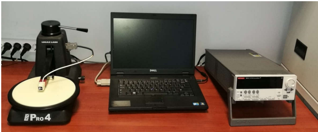
Şekil 5.63. Keithley 2601A Lucas Labs PRO4 cihazının fotoğrafı.
