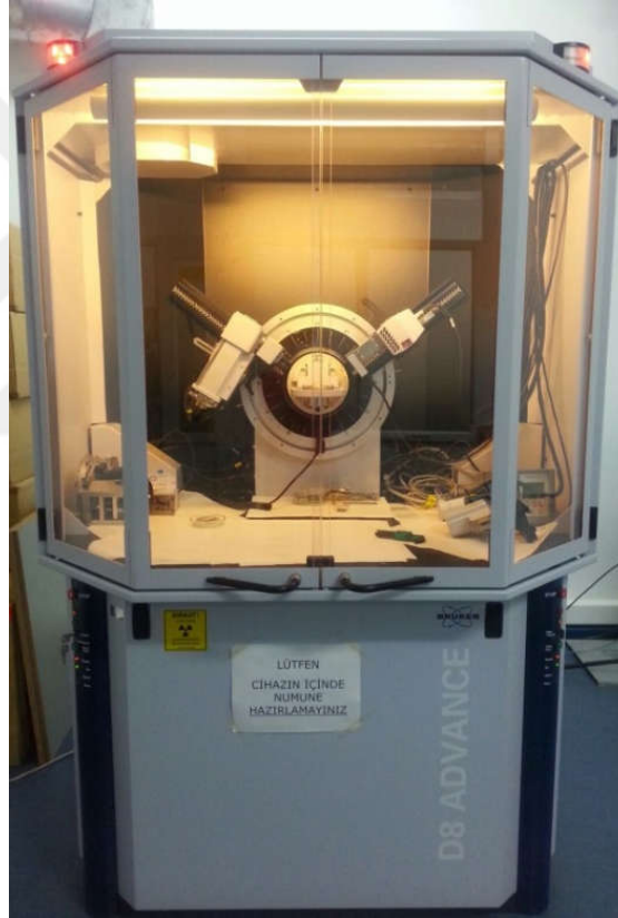
Şekil 5.2. D8 ADVANCE BRUKER marka x ışını kırınım cihazı.
