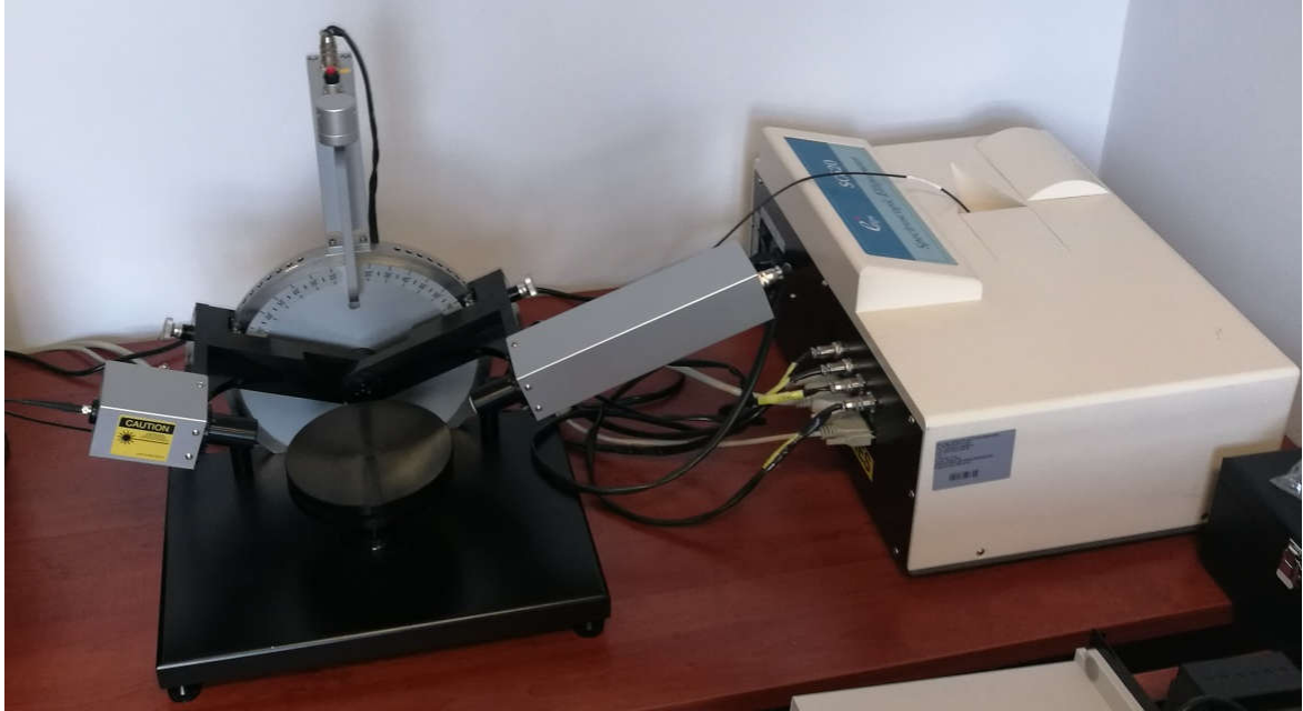
Şekil 5.6. OPT-S9000 Spektroskopik Elipsometre cihazının fotoğrafı.
