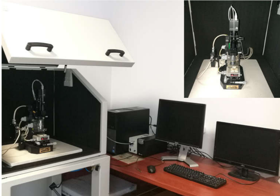
Şekil 5.31. Bu tez çalışmasında kullanılan AFM cihazının fotoğrafı.
