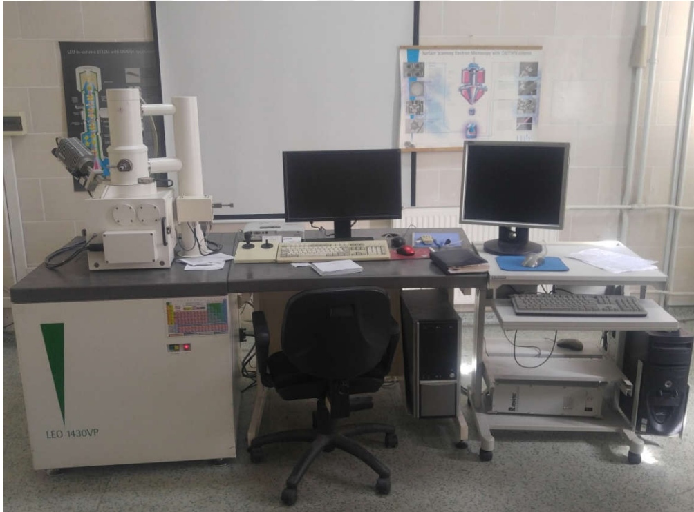
Şekil 5.43. Taramalı Elektron Mikroskobu (SEM) cihazının fotoğrafı.
