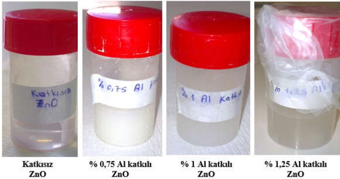
Şekil 4.5. Deneyde elde edilen katkısız ZnO, % 0,75 Al katkılı ZnO, % 1 Al katkılı ZnO ve % 1,25 Al katkılı ZnO filmlerinin çözeltilerinin fotoğrafları.
