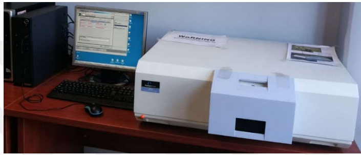
Şekil 5.27. “Perkin Elmer LS55 Fluorescence Spectrometer” cihazının fotoğrafı.
