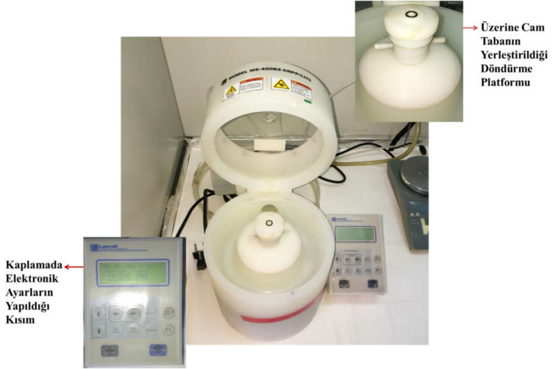
Şekil 4.7. WS-400-6NPP-Lite Laurell markalı döndürerek kaplama cihazı.
