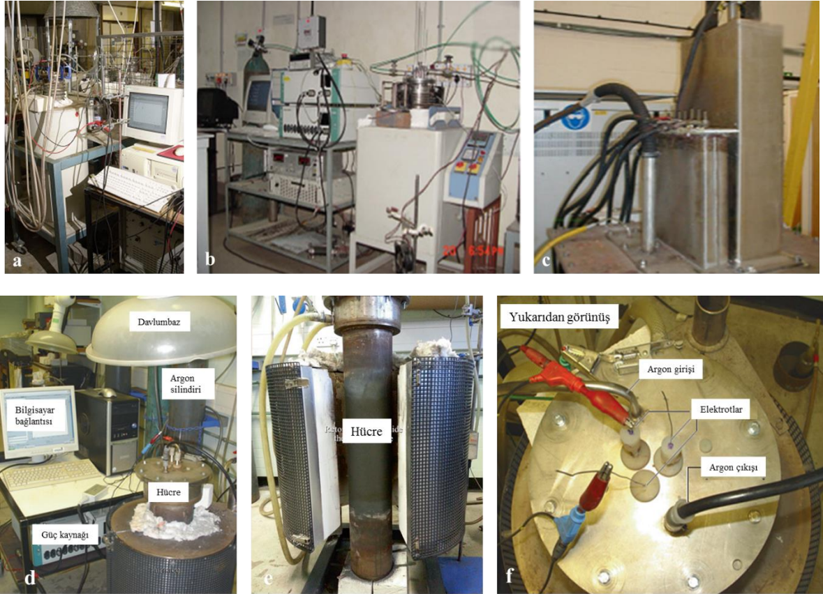
Şekil 2. 3 a) Elektro-deoksidasyon deney düzeneği (Mohandas vd., 2011) b) elektro-deoksidasyon pilot üretim üst kısmı (Schwadt vd., 2010) (d, e, f) diğer bir elektro-deoksidasyon deney düzeneği (Hu ve Chen, 2017).
