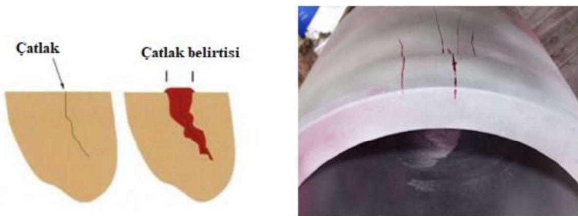
Şekil 2.2. Penetran sıvısı ile muayene edilen yüzeye bir örnek (Anonim, 2016)
