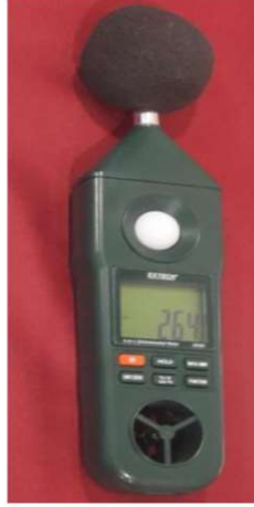
Şekil 6.8. Çok fonksiyonlu çevresel faktörler ölçüm cihazı
