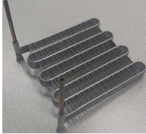
Şekil 6.2 Düz plaka kanatlı ısı değiştirici
