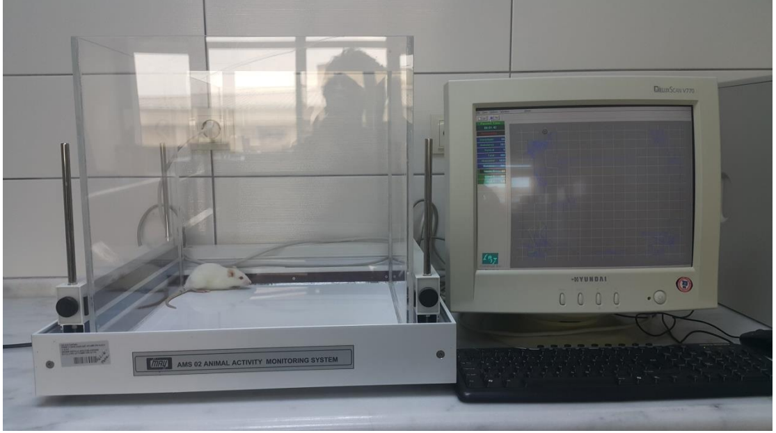
Şekil 3.4. Aktivitemetre test düzeneği.
