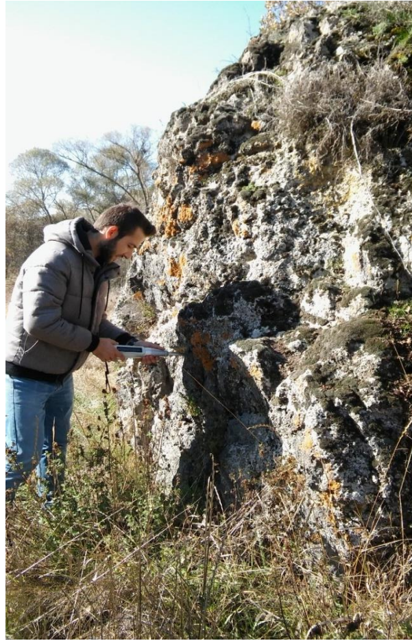
Şekil 5.18. Düşen blokta Schmidt çekici sertlik ölçümünden bir görünüm.
