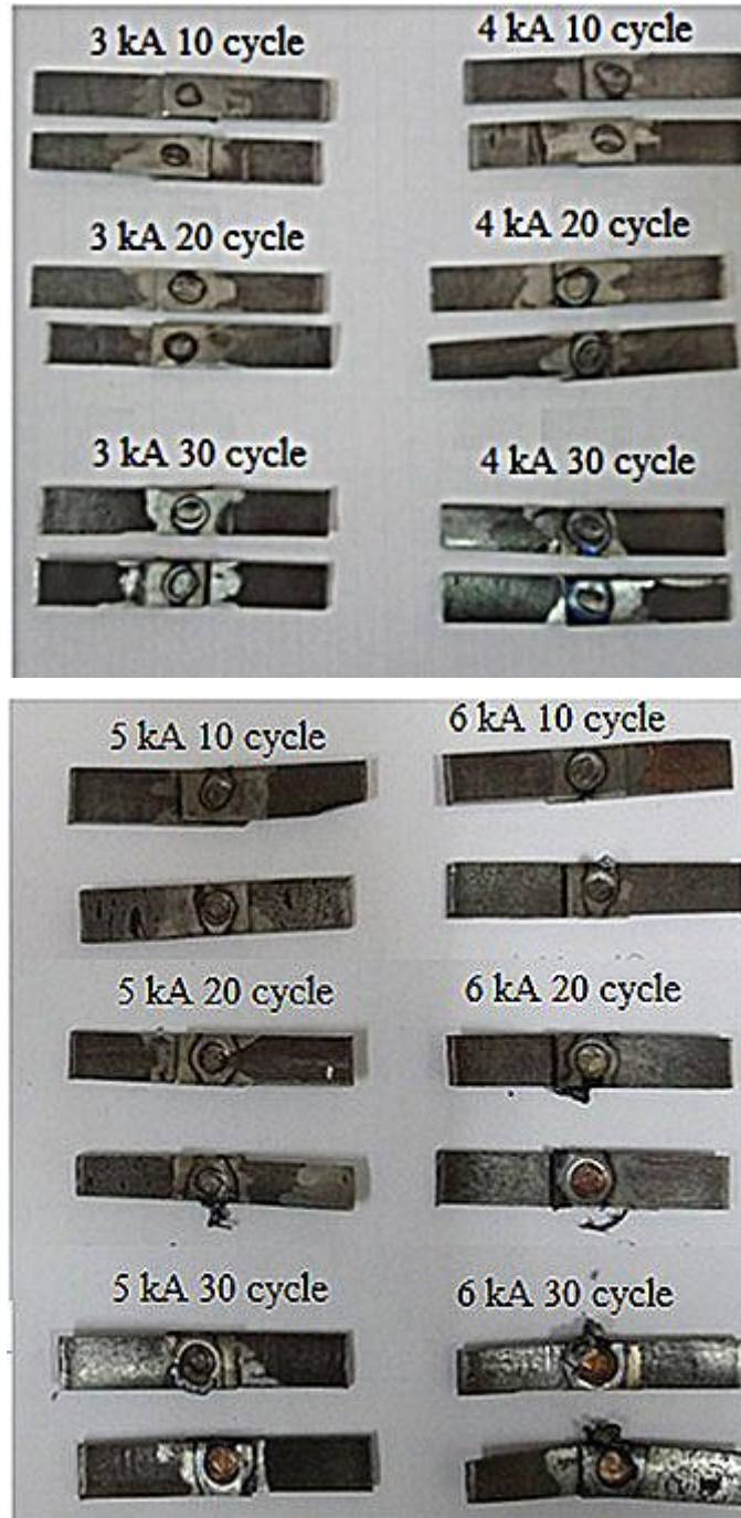
Şekil 4.2. 1000 N elektrot kuvveti altında kaynaklanan numunelerin makro fotoğrafları
