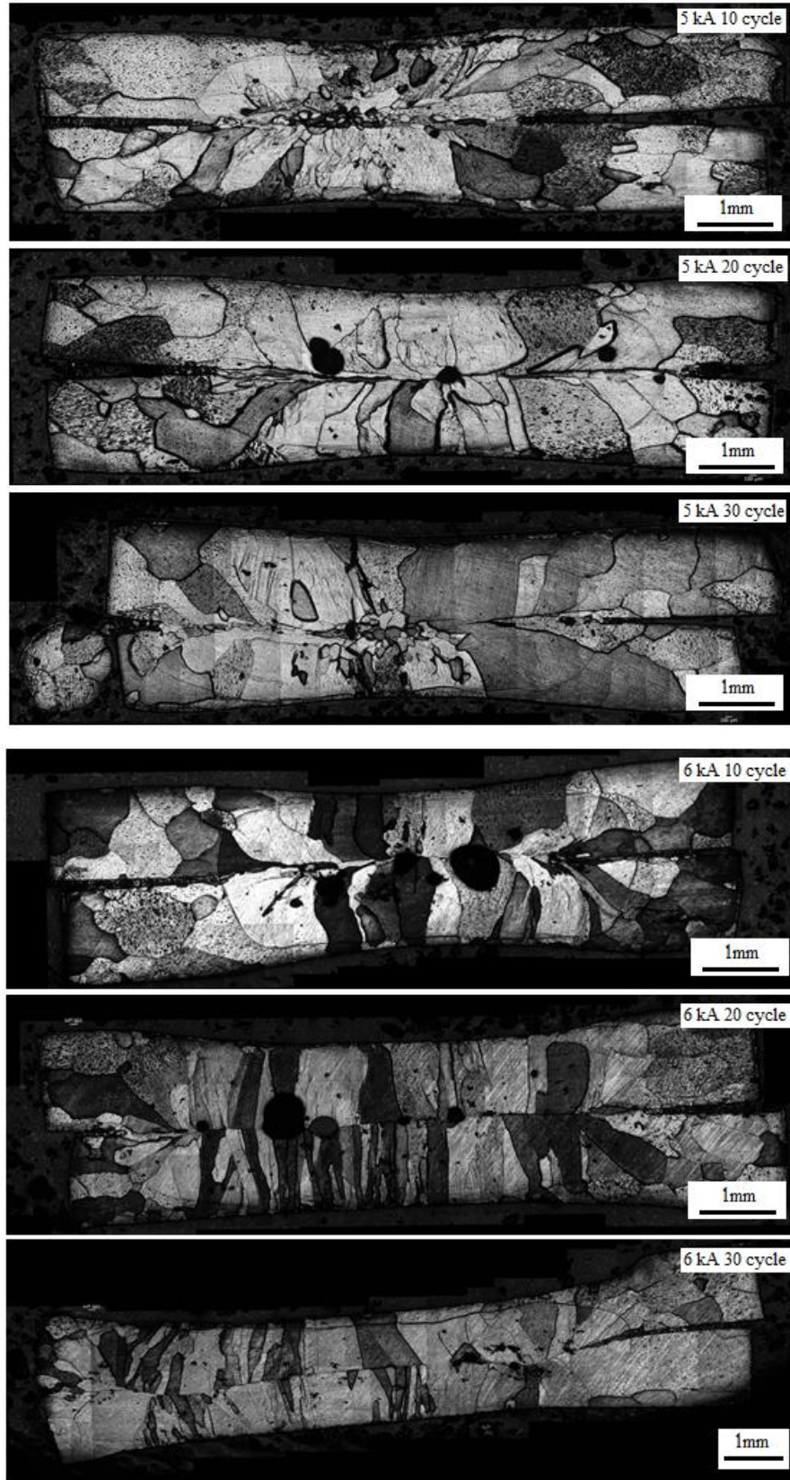
Şekil 4.4. 500N elektrot kuvveti altında kaynaklanan 5kA ve 6kA'lık numunelerin optik mikroyapı fotoğrafları
