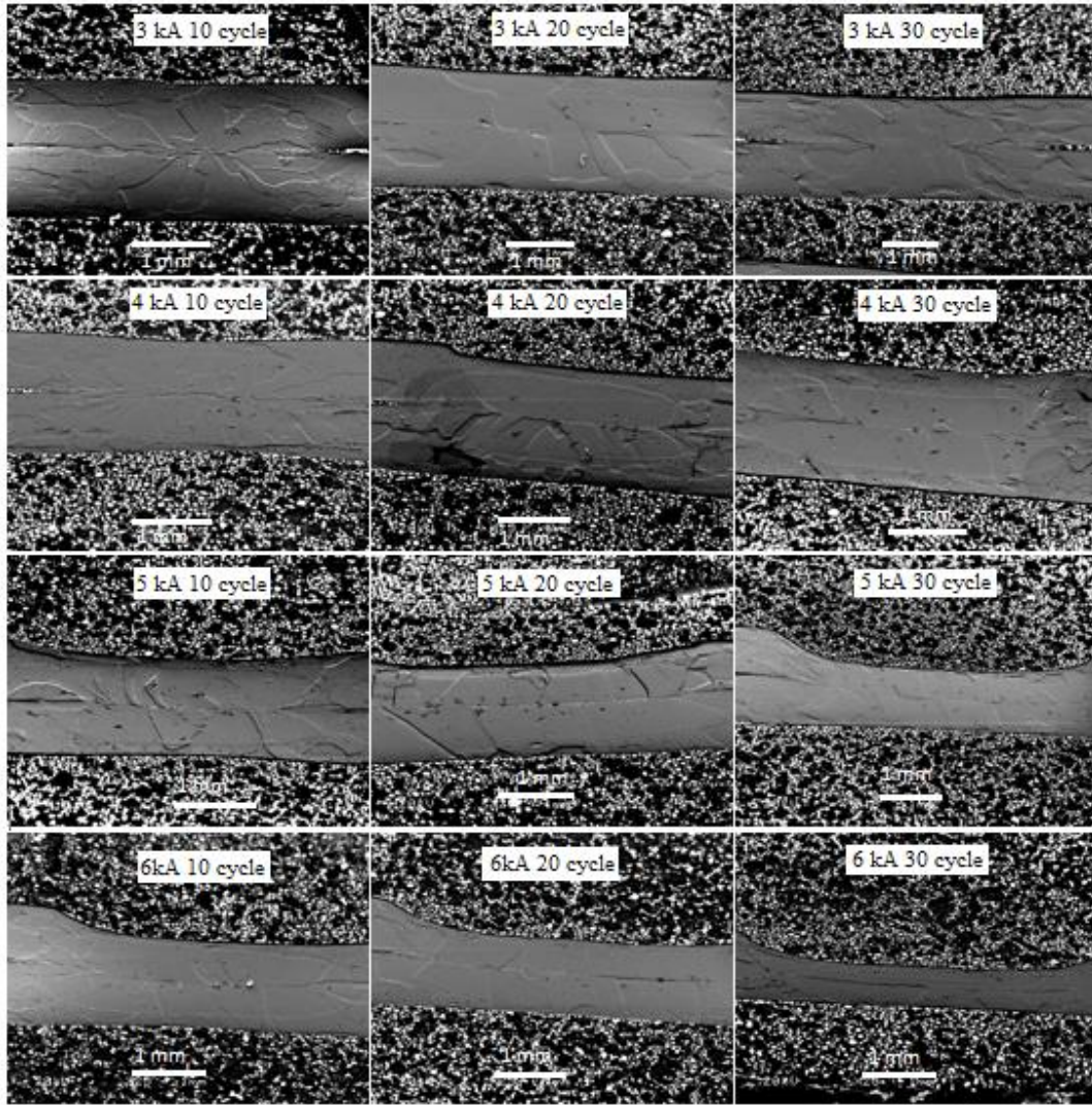
Şekil 4.9. 1000N elektrot kuvveti altında kaynaklanan numunelerin küçük büyütme SEM fotoğrafları
