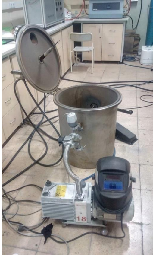
Şekil 3.1. Vakumlu ark ergitme ocağı.
