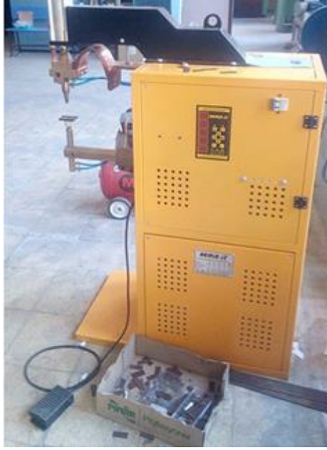
Şekil 3. 4. Su soğutmalı pnömatik nokta direnç kaynak makinesi.
