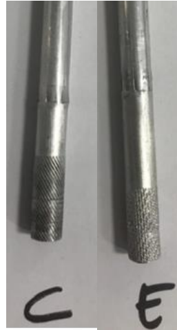
Şekil 6.1. Test sonuçlarına göre en iyi test sonucu alınan tırtıl desenleri
