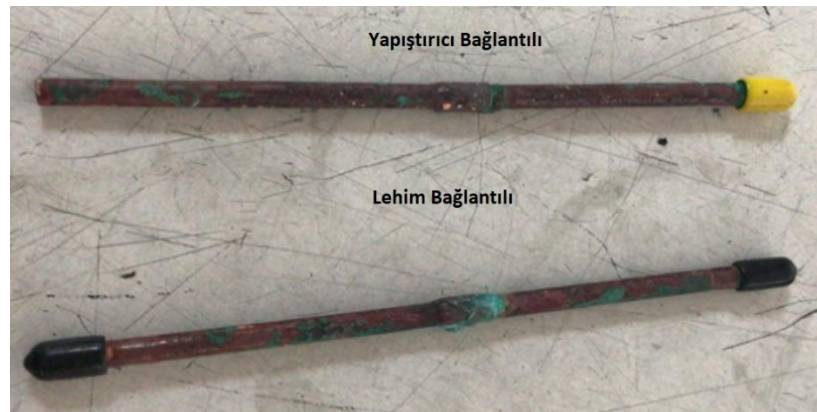
Şekil 5.11. Bakır boruların korozyon testi sonuçları
