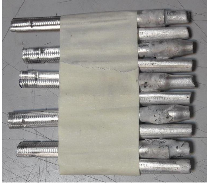
Şekil 5.8 Lehim bağlantılı alüminyum boruların test sonrası görüntüsü
