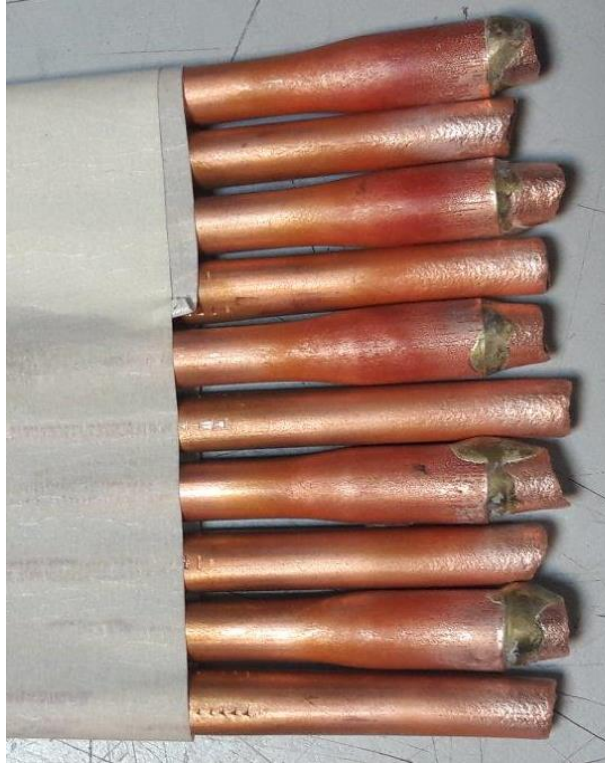
Şekil 5.5 Lehim bağlantılı bakır boruların test sonrası görüntüsü
