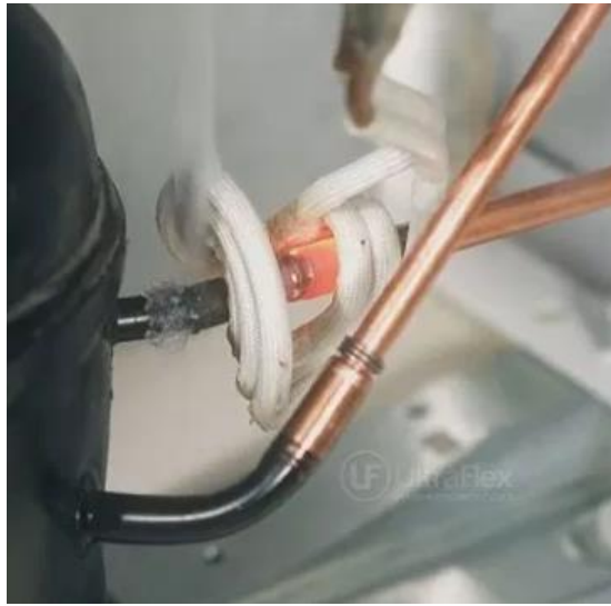
Şekil 2.9. Kompresör bağlantısında indüksiyon ile birleştirme (Ultraflex.com,2018)
