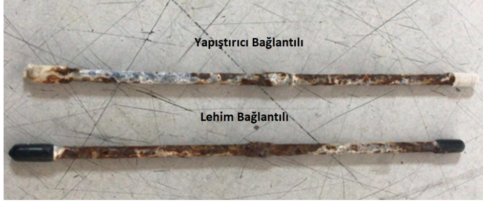
Şekil 5.10. Çelik boruların korozyon testi sonuçları
