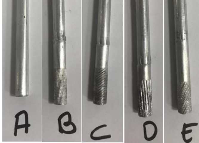
Şekil 4.5. Soğutucu borulara uygulanan tırtıl formları
