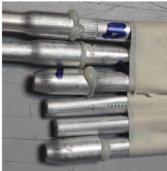
Şekil 5.7 Yapıştırma bağlantılı alüminyum boruların test sonrası görüntüsü
