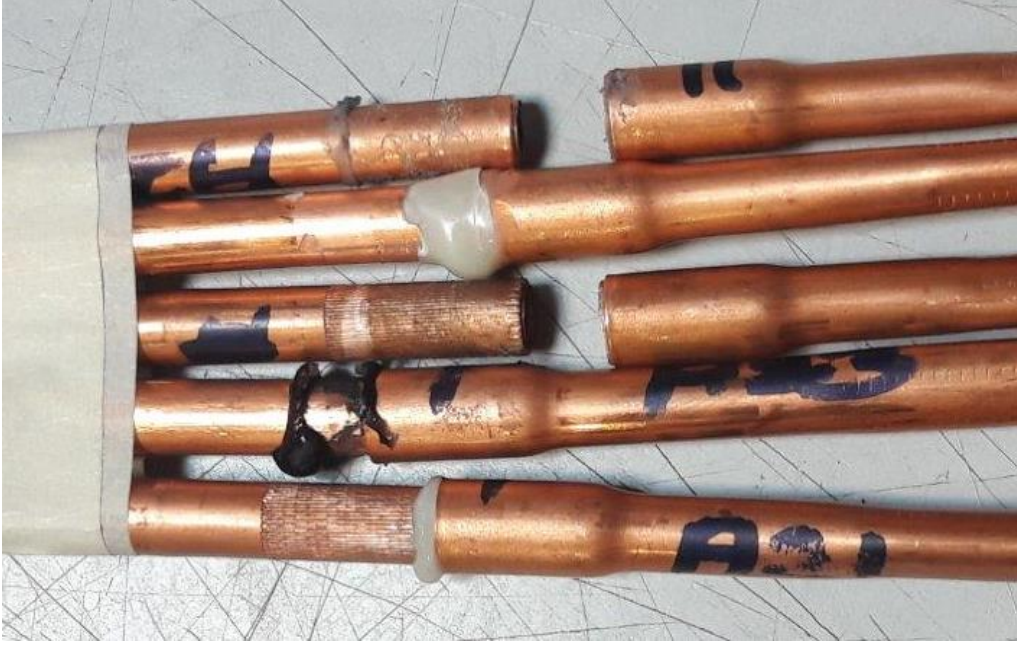
Şekil 5.4 Yapıştırma bağlantılı bakır boruların test sonrası görüntüsü
