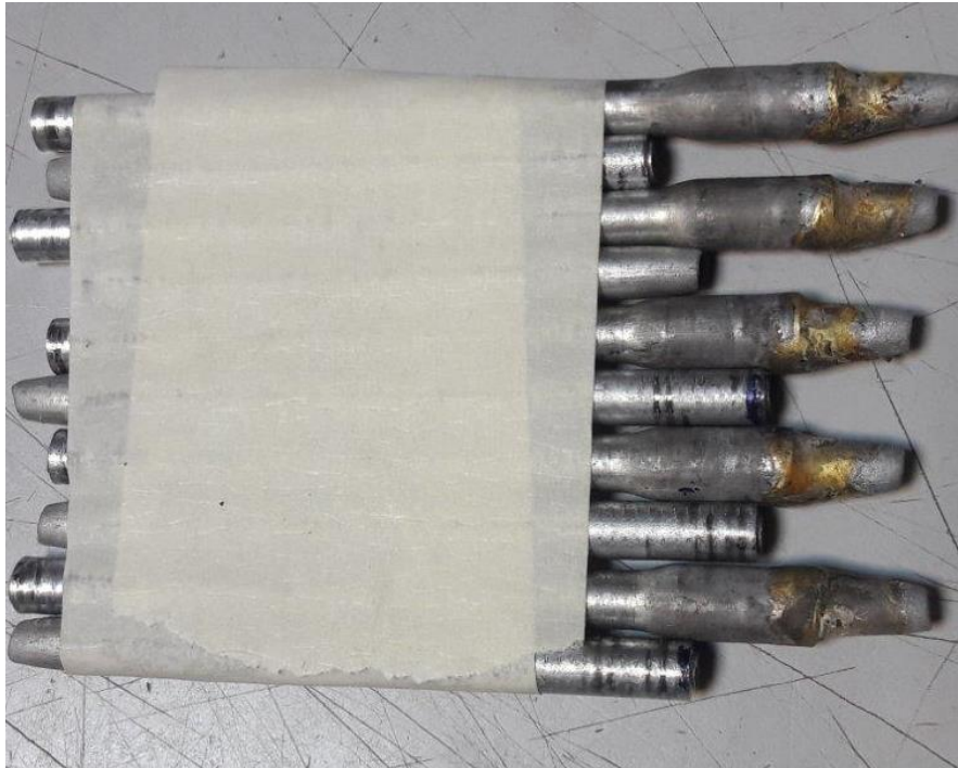
Şekil 5.2 Lehim bağlantılı çelik boruların test sonrası görüntüsü
