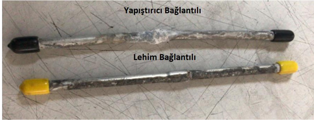
Şekil 5.12. Alüminyum boruların korozyon testi sonuçları
