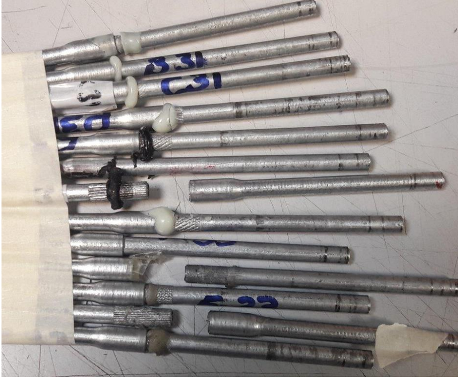
Şekil 5.1 Yapıştırma bağlantılı çelik boruların test sonrası görüntüsü
