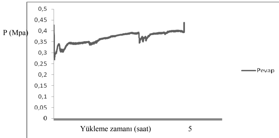
Şekil A.20 Çevre sıcaklığı 30°C ve % 70 nemlilik koşulunda evaporatör basıncının yükleme zamanı boyunca değişimi
