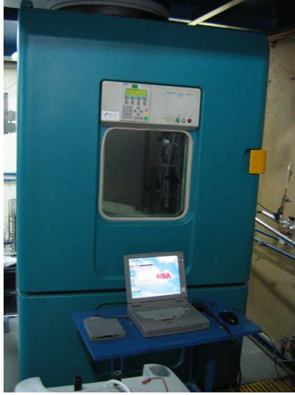
Şekil 3.4 Çevre koşullarının simülasyonunda kullanılan iklimik kabin
