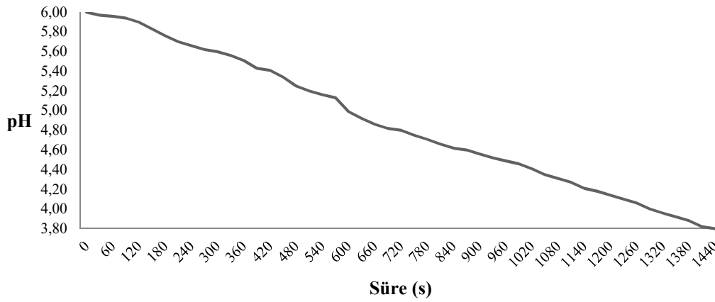
Şekil 4.37. Referans olarak hazırlanan plastik haline getirilen bileşiğin DHC eğrisi
