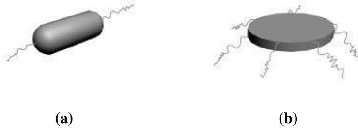
Şekil 2.2. Sıvı kristal moleküllerinin şekilleri: (a) kalamatik ve (b) diskotik
