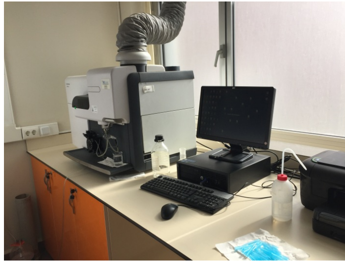
Şekil 4.9. Plazma Atomik Emisyon Spektrometresi
