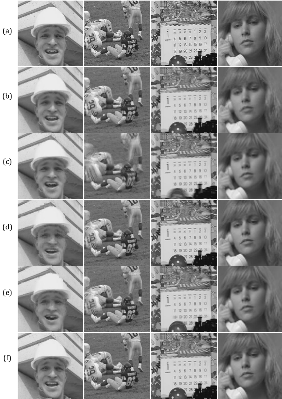
Şekil 4.5. Dönmeli VBS-ME yöntemin görsel sonuçları: a) Orijinal resim, b) Bikübik ara değerlendirme, c) Global kayıt, d) 8 \times 8 blok boyutlu ES, e) 8 \times 8 blok boyutlu AS, f) AS (VBS-ME) ait sonuçlar
