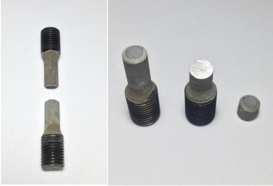
Şekil 6.4. Yüksek sertlikli çekme kuponlarına ait çekme deneyi sonucu kopma yüzeyleri
