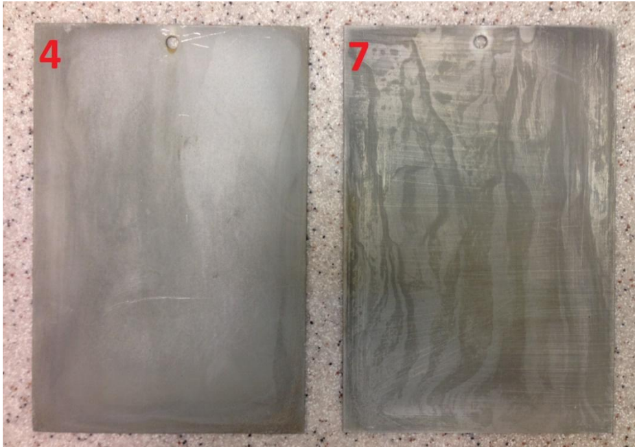
Şekil 6.21. Minimum kalınlığa sahip 4 numaralı Cad ve 7 numaralı Ti-Cad kaplanmış numunelerin tuz sisi deneyi sonrası karşılaştırmalı yüzey görüntüleri
