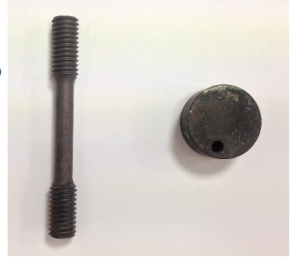
Şekil 5.1. Çelik malzemeler için ASTM E8 Fig 8 Speciman 3’e uygun çekme test numuneleri
