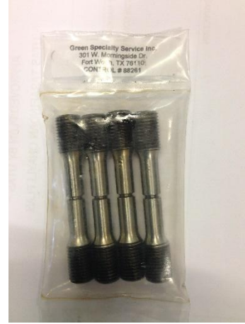
Şekil 5.2. Çelik malzemeler için ASTM F519 Tip 1a.1'e uygun çekme test numuneleri
