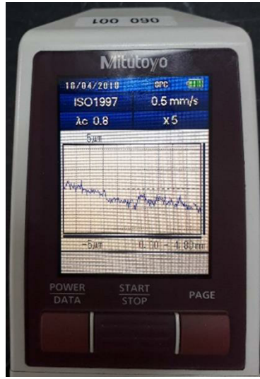
Şekil 6.1. Bilyalı Dövme Öncesi Yüzey Pürüzlülüğü Ölçümü
