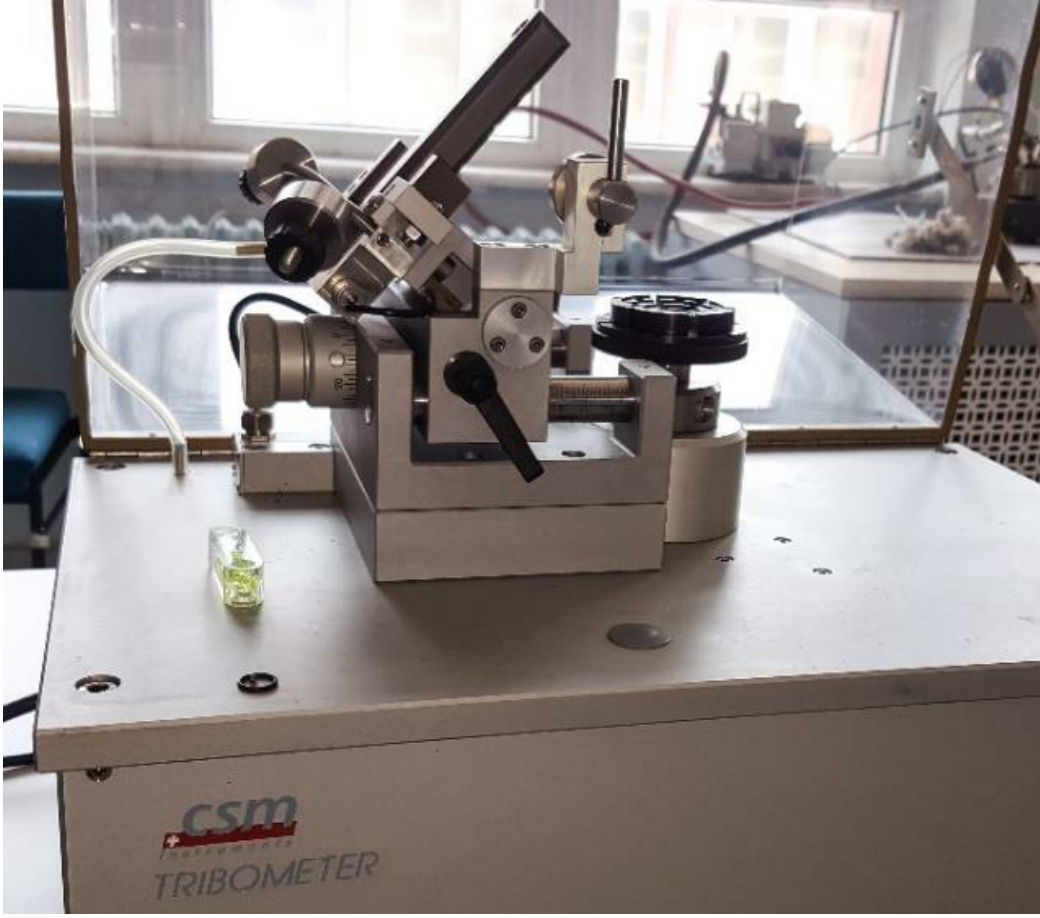
Şekil 5.10. CSM Tribometer Aşınma Test Cihazı
