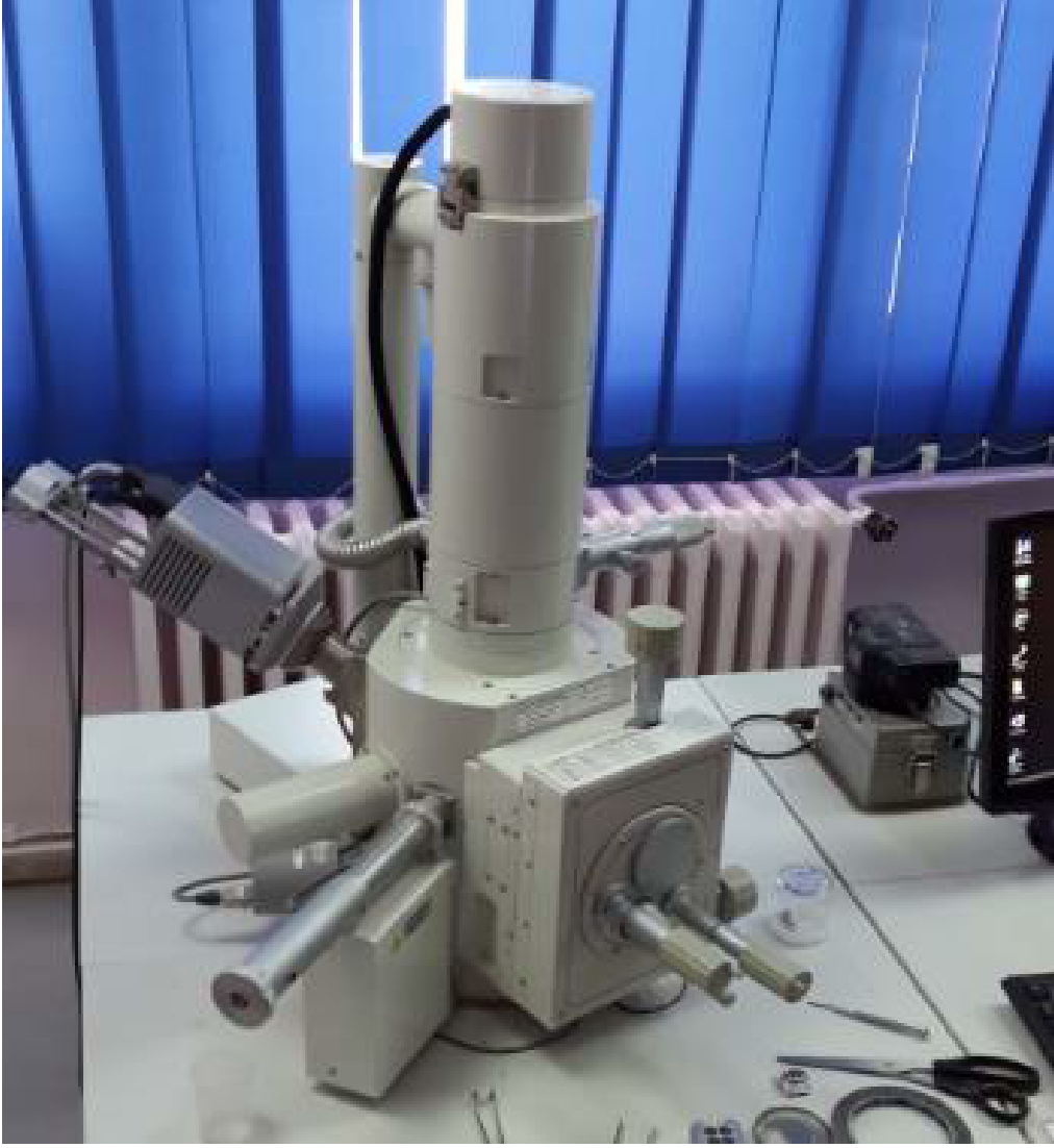
Şekil 5.11. JEOL JSM-5600LV Taramalı Elektron Mikroskobu
