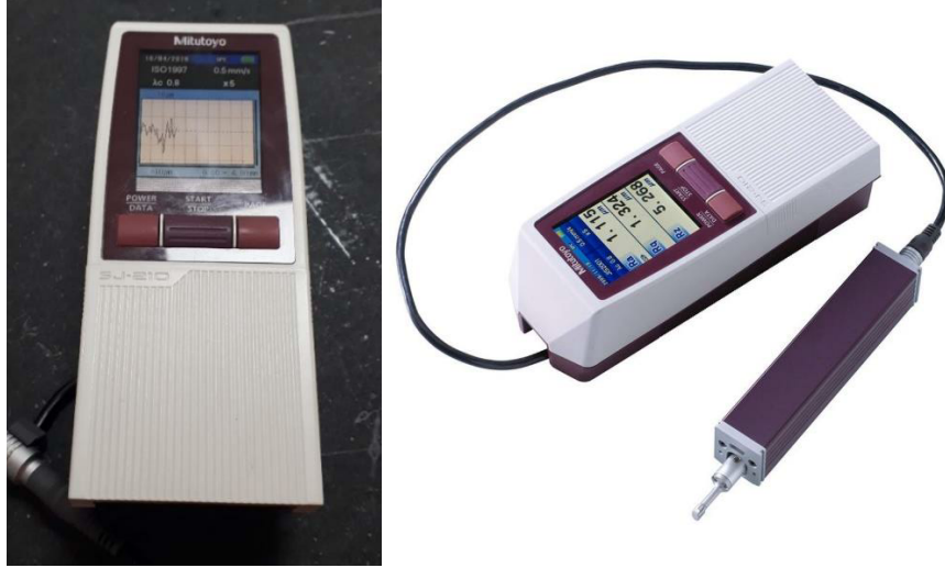
Şekil 5.3. Mitutoyo SJ-210 Yüzey Pürüzlülüğü Ölçüm Cihazı
