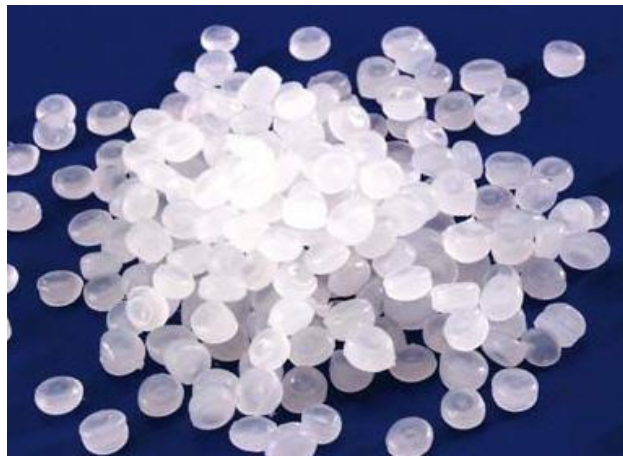
Şekil 2.2. Polietilen Hammadde (Karabulut ve Seydibeyoğlu 2015).
