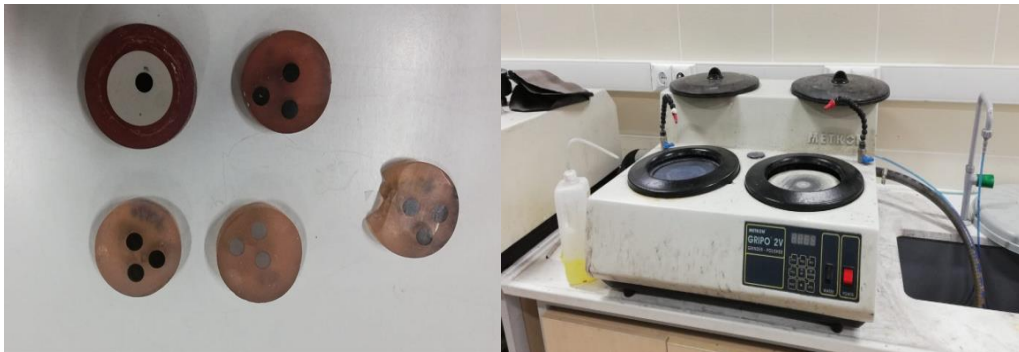
Şekil 3.5. a) Kalıplanmış Numuneler, b) Zımparalama ve parlatma makinesi
