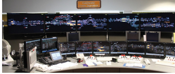
Şekil 2.17: Merkezi Trafik Kontrolü ( Evolution of Signalling Control )
