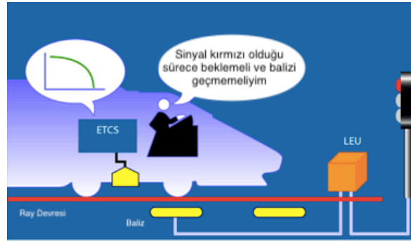
Şekil 2.2: Seviye 1 için tren üstü ve hat boyu ekipman ( ERTMS Signalling Levels )
