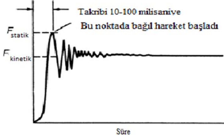
Şekil 4.5. Süreye bağlı olarak sürtünme kuvvetleri değişimi (Bhushan, 2013)
