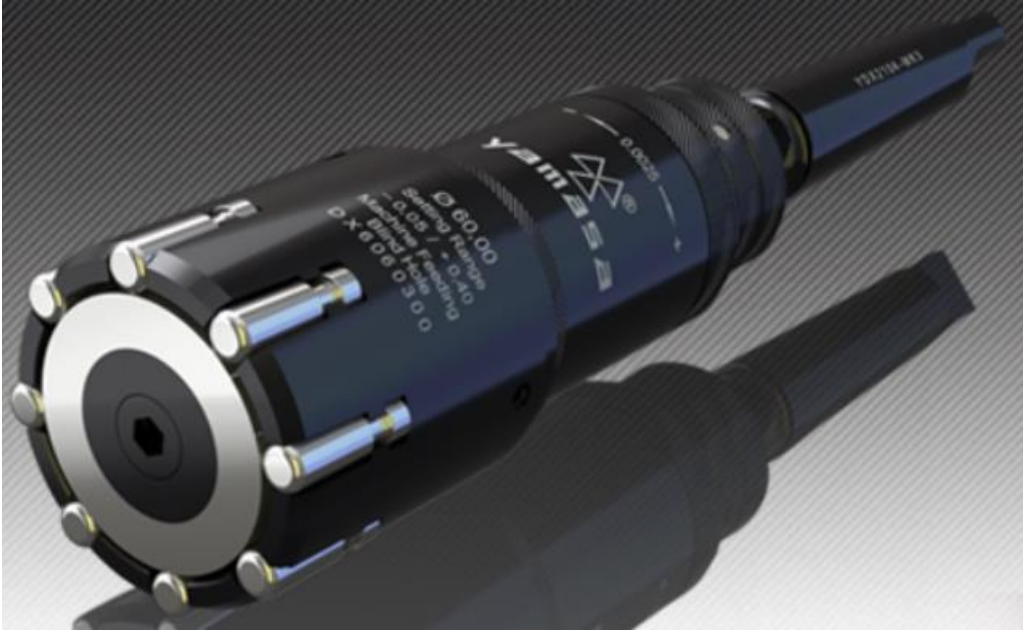
Şekil 3.5. Silindirik Parlatma Takımı (Anonim, 2018)
