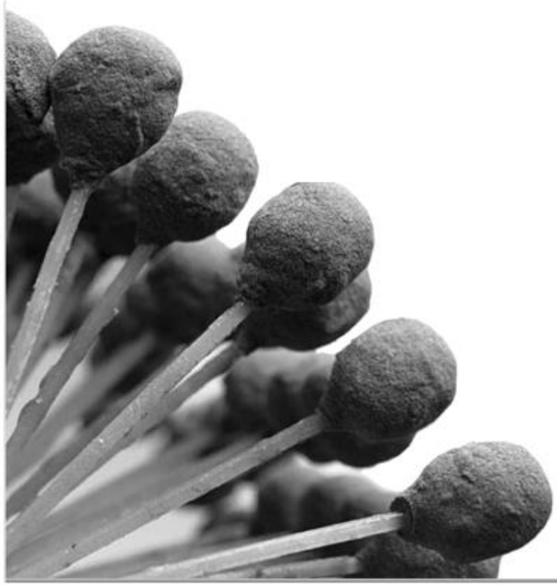
Şekil 3.2. Esnek Honlama Aşındırıcı Topları (Anonim, 2018)
