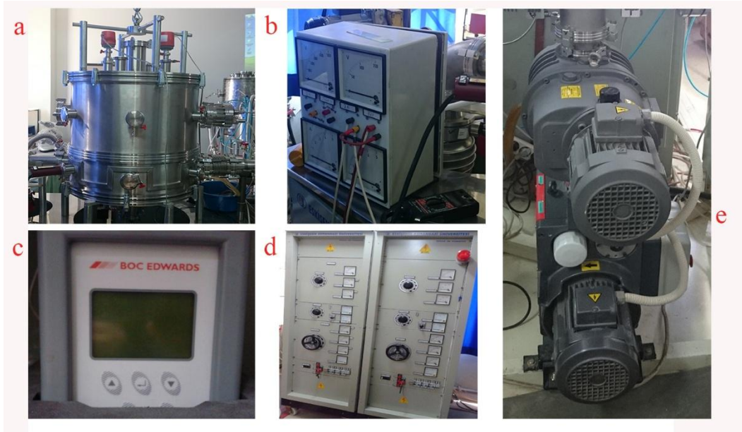
Şekil 4.6 Deney sırasında kullanılan a) vakum odası, b) akım ve voltmetre, c) basınç ölçer kontrol, d) güç kaynağı ve e) mekanik pompa'nın fotoğrafları
