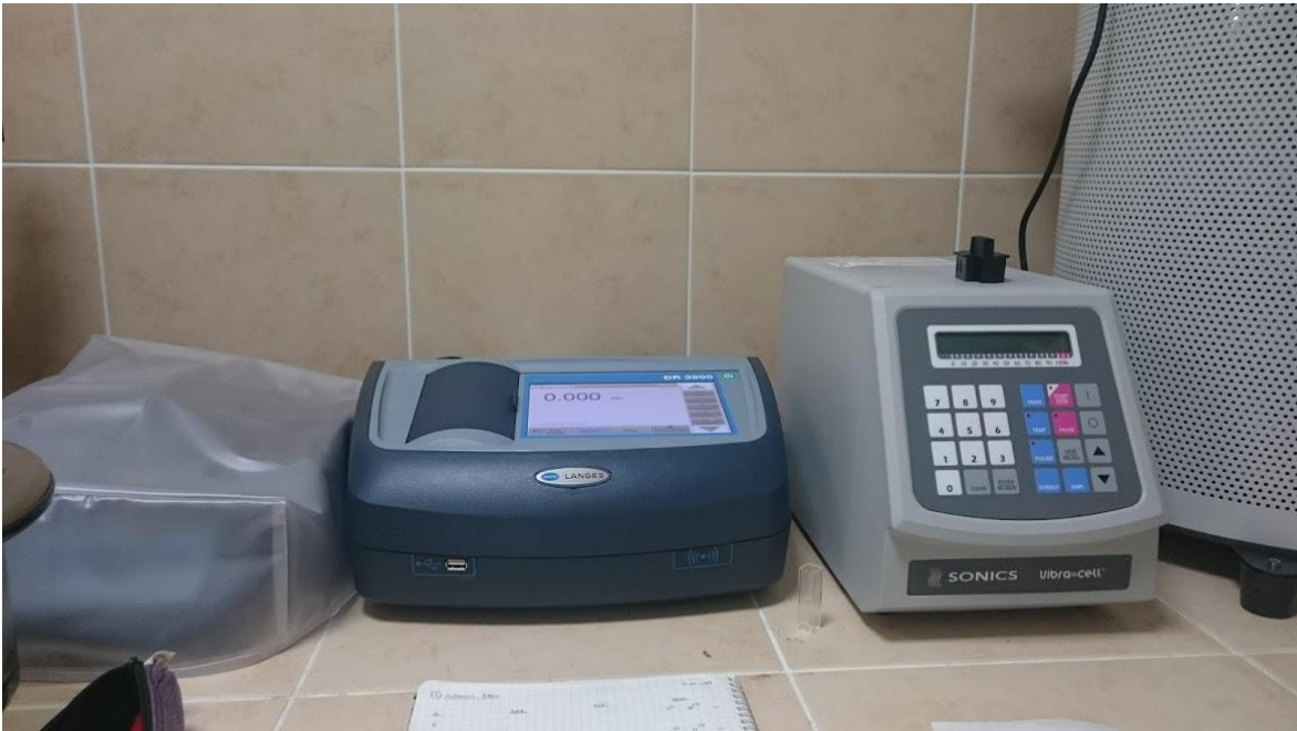
Şekil 6.1. Kullanılan Hach Lange marka DR 3900 model spektrofotometre
