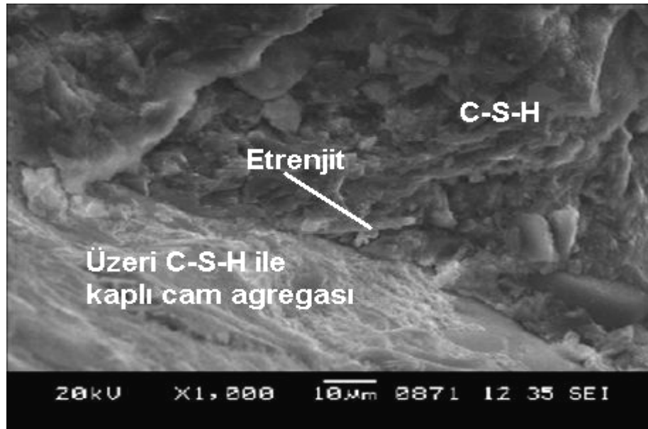
Şekil 7.80. K4 örneğine ait 1000 büyütme mikroskobu fotoğrafı.
