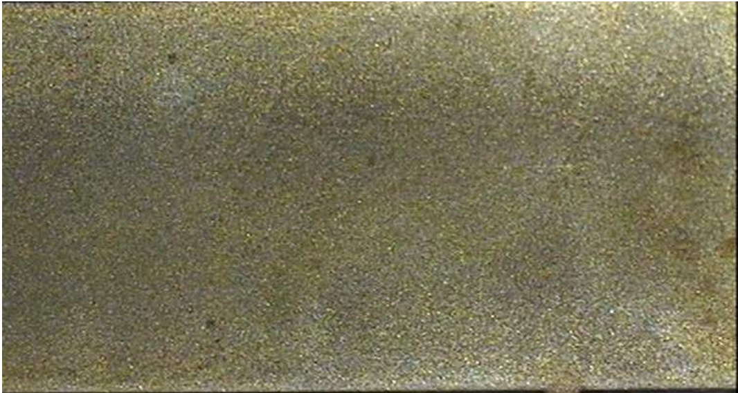
Şekil 4.43. 100 saat tuz testi sonrasında Tribaloy 400 kaplamalı kupon
