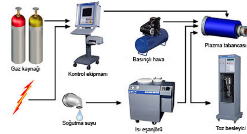
Şekil 2.6. Plazma sistemi (Sulzer Metco, 2010).
