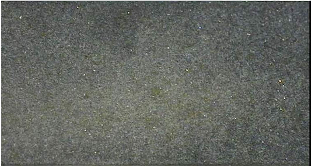
Şekil 4.41. 100 saat tuz testi sonrasında alüminyum oksit kaplamalı kupon
