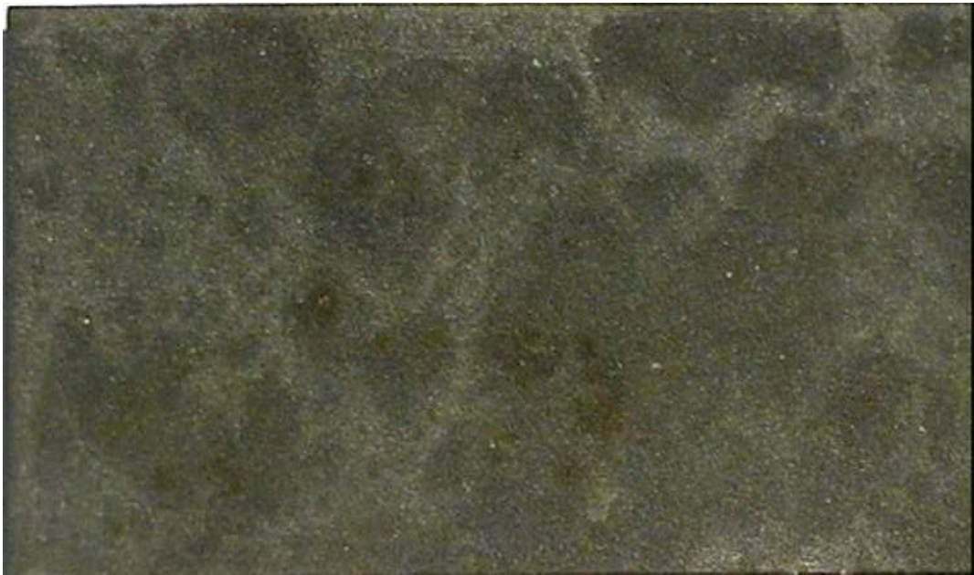
Şekil 4.47. 100 saat tuz testi sonrasında krom karbür kaplamalı kupon
