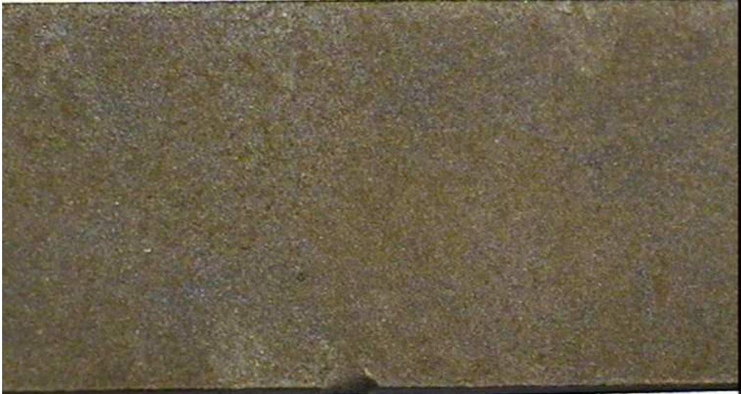
Şekil 4.45. 100 saat tuz testi sonrasında tungsten karbür kaplamalı kupon
