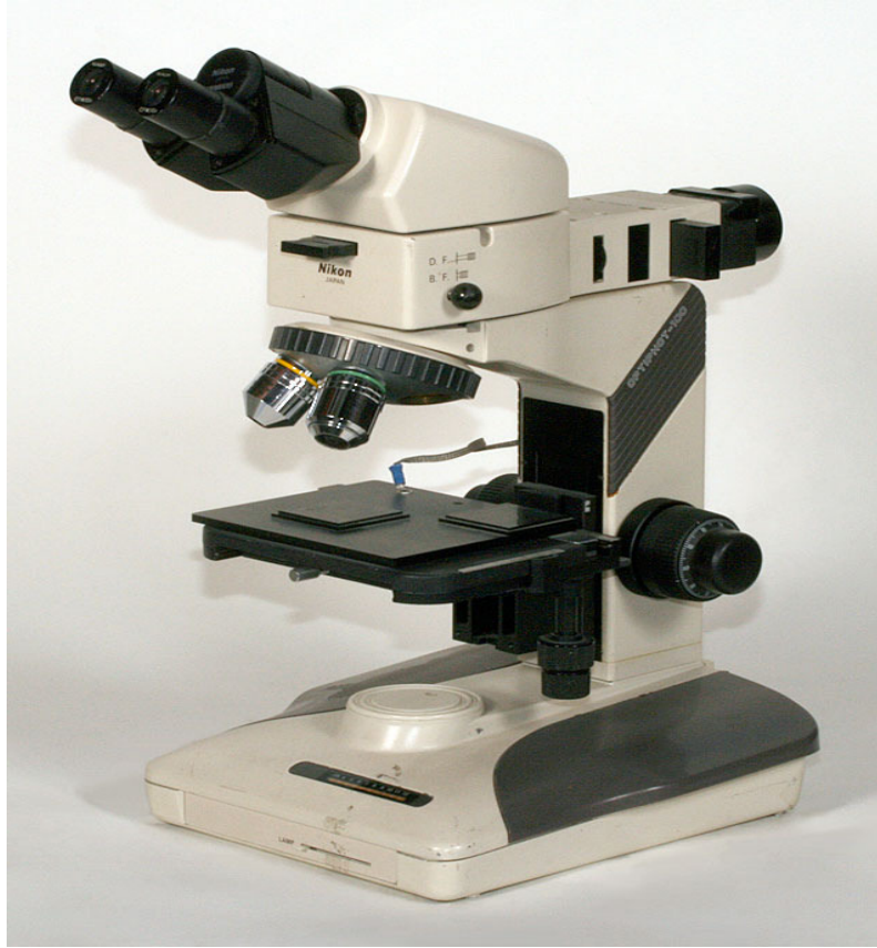
Şekil 3.3. Nikon Optiphot 100 model optik mikroskop
