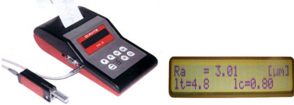
Şekil 3.1. Portatif yüzey pürüzlülüğü ölçüm cihazı.
