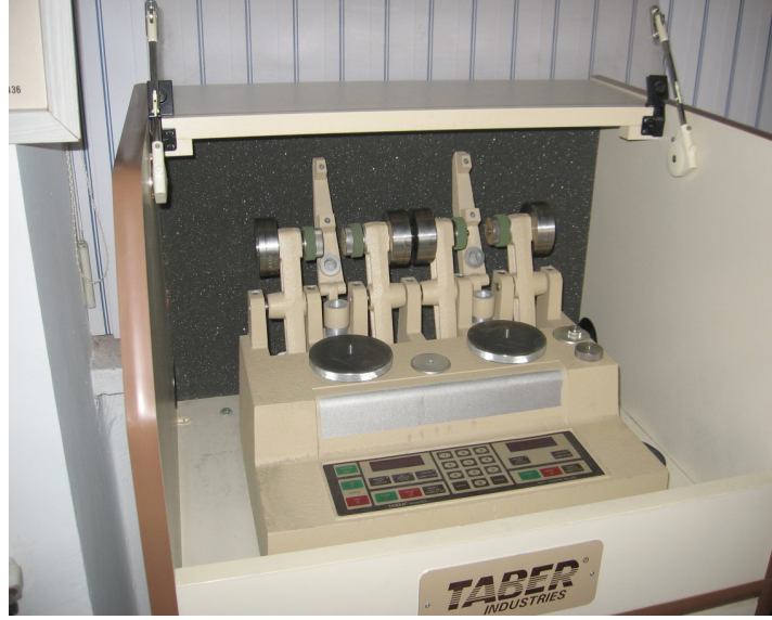
Şekil 3.4. Taber 5131 aşınma test cihazı
