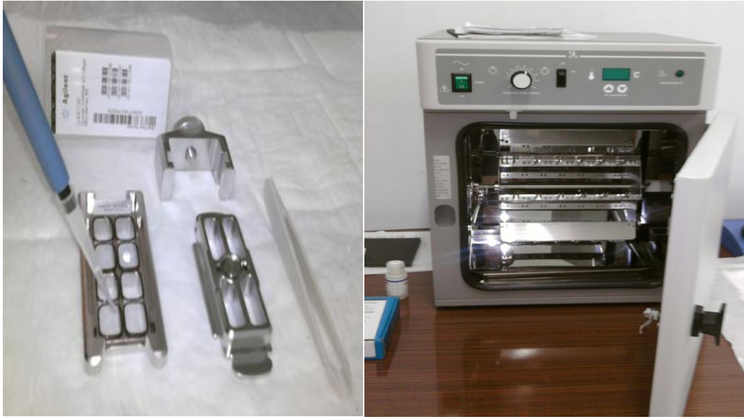
Şekil 3.2. Hibridizasyon hücresinin tabanındaki gasket slayta örnek yüklenmesi- Hibridizasyon fırını
