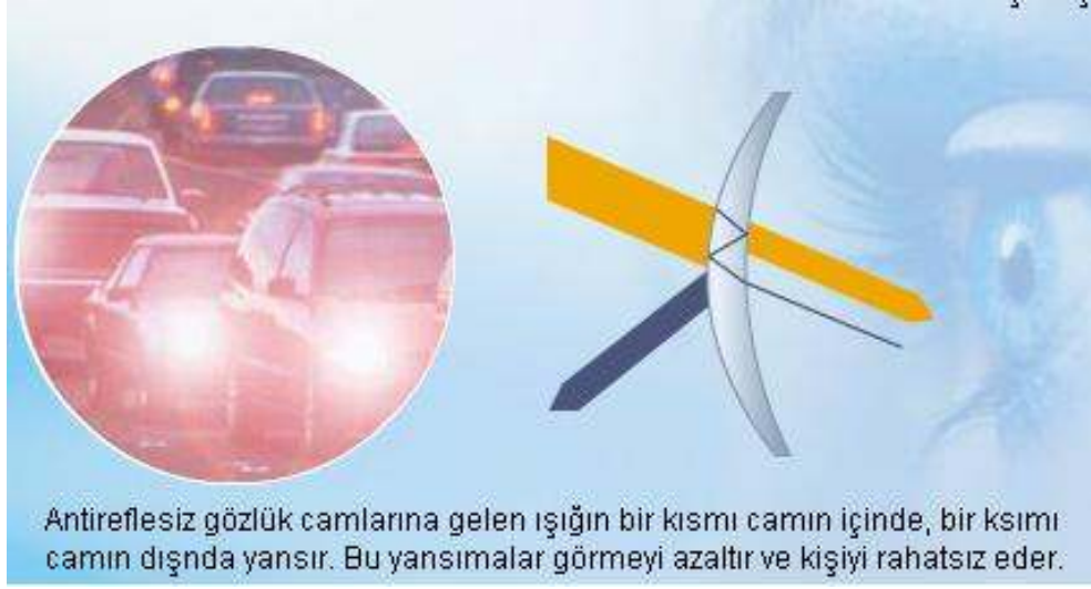
Şekil 3.6. Anti-refle kaplamasız bir gözlük camından bakan gözlemcinin görüşü
