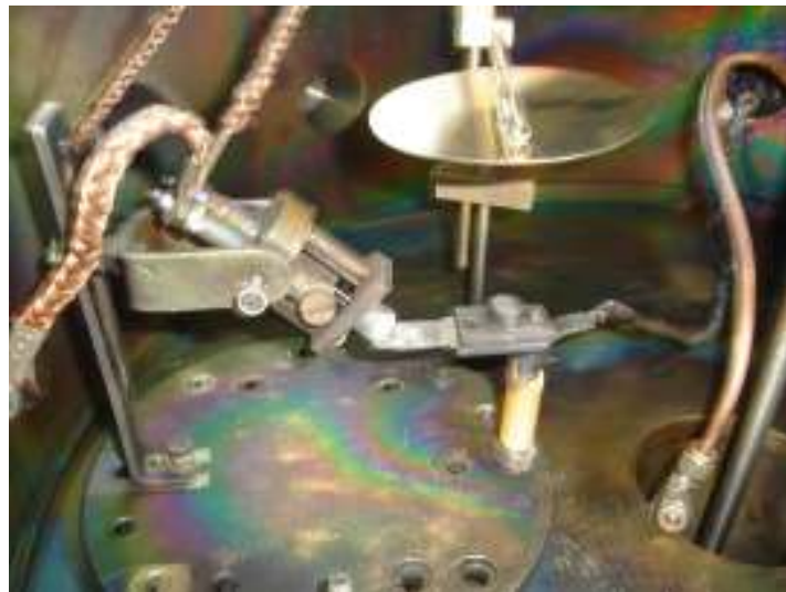
Şekil 6.3. Kapayıcı (shutter) ile birlikte elektron tabancası ve potanın fotoğrafı.
