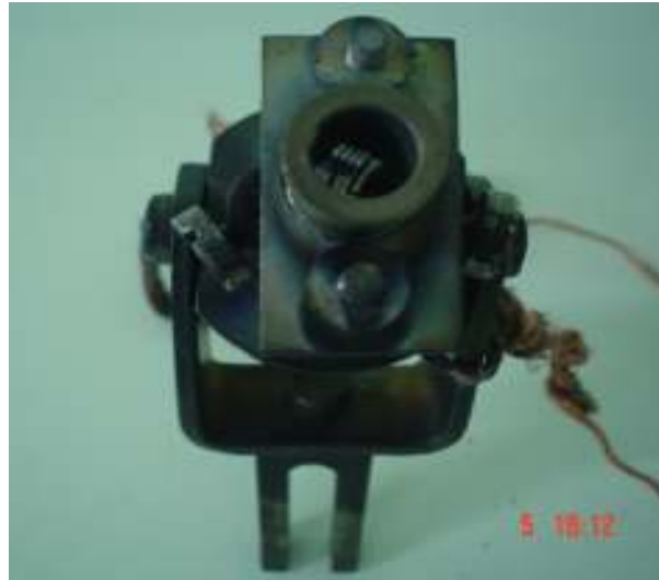
Şekil 5.4 Doğrudan ısıtmalı katodun (elektron tabancası) fotoğrafı (Balbağ, 2009)
