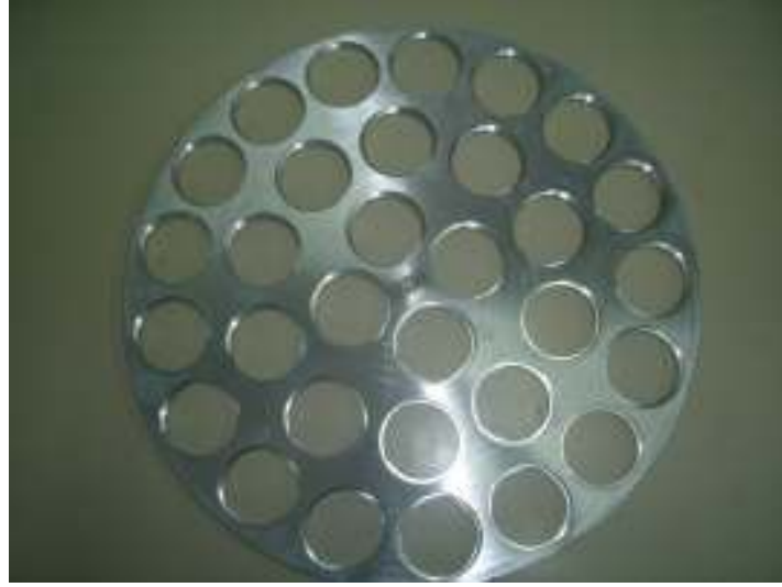
Şekil 6.2. Gözlük camı tutucunun fotoğrafı.
