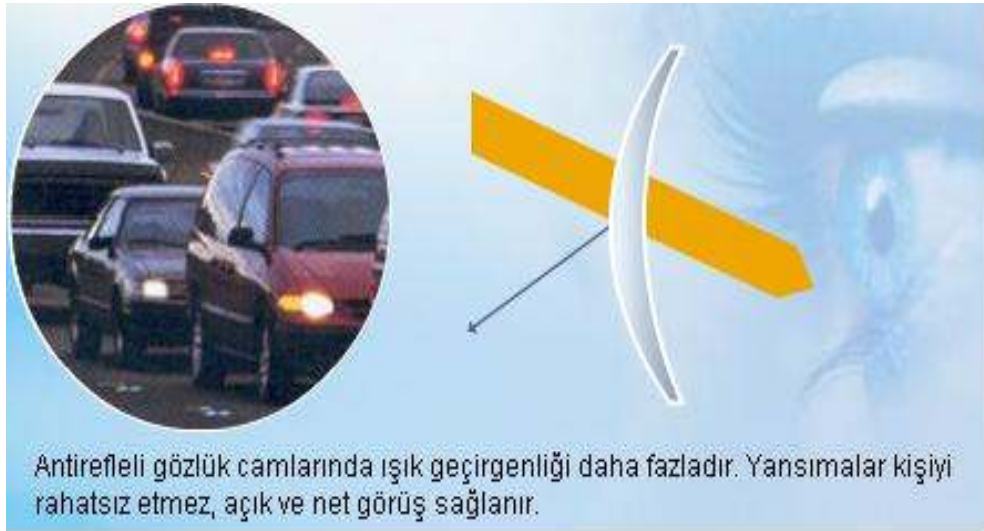
Şekil 3.7. Anti-refle kaplamalı bir gözlük camından bakan gözlemcinin görüşü
