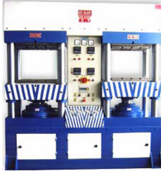
Şekil 3.6. Tek etkili ağırlık etkisi ile geri dönüşlü hidrolik pres (MEGEP Bükme Kalıpları 3, 2006)
